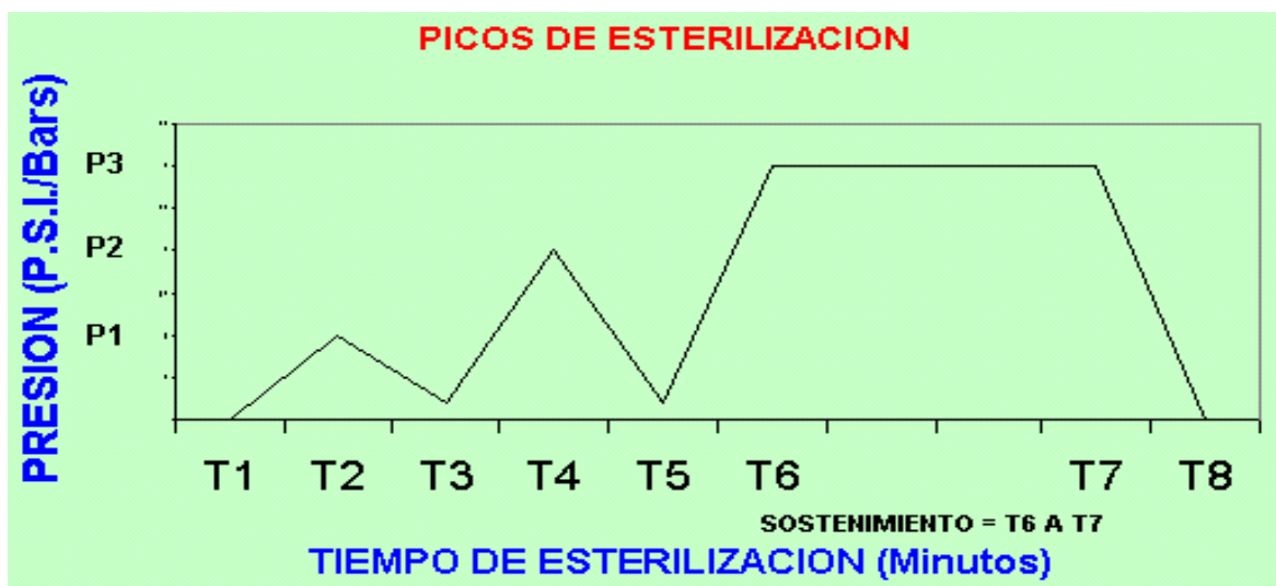
Figura 8. Picos de expansión de la presión de vapor del proceso de esterilización.
