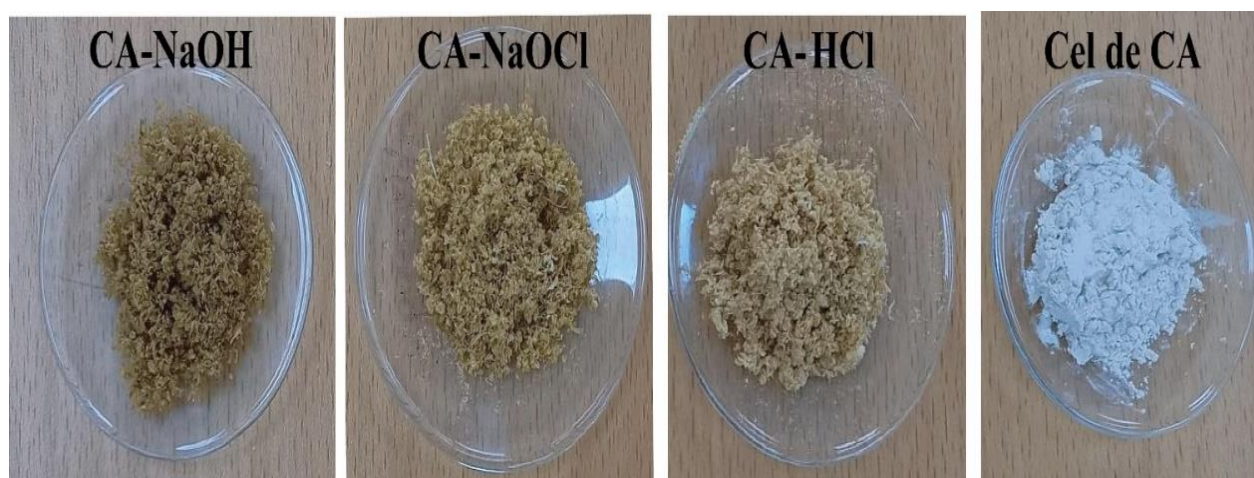
Figura 7. Proceso de obtención de la Cel de CA a partir de la CA.
