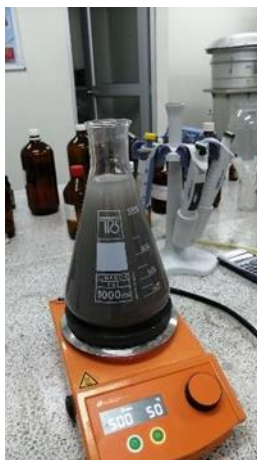
Figura 16 Reactor Batch a escala laboratorio tratamiento por Peróxido de Hidrógeno catalizado con Bicarbonato de Sodio
