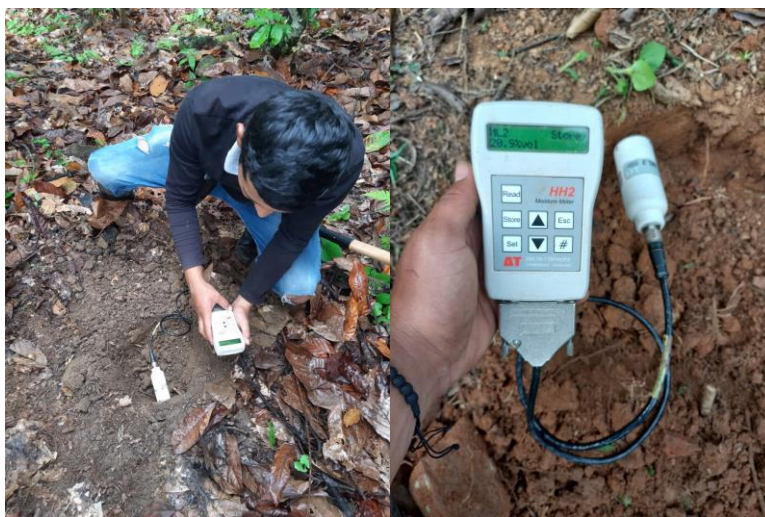
Figura 3. Determinación de humedad volumétrica
