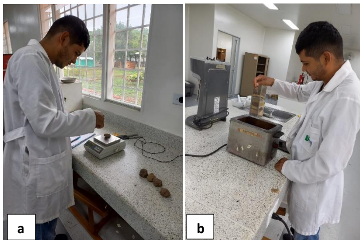
Figura 4. Determinación de la densidad aparente D_a . a. Peso del terrón sin parafina. b. Terrón sumergido en parafina
