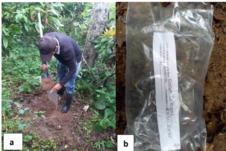
Figura 1. Toma de muestras. a. Recolección de la muestra en doble funda plástica. b. Tarjeta de identificación
