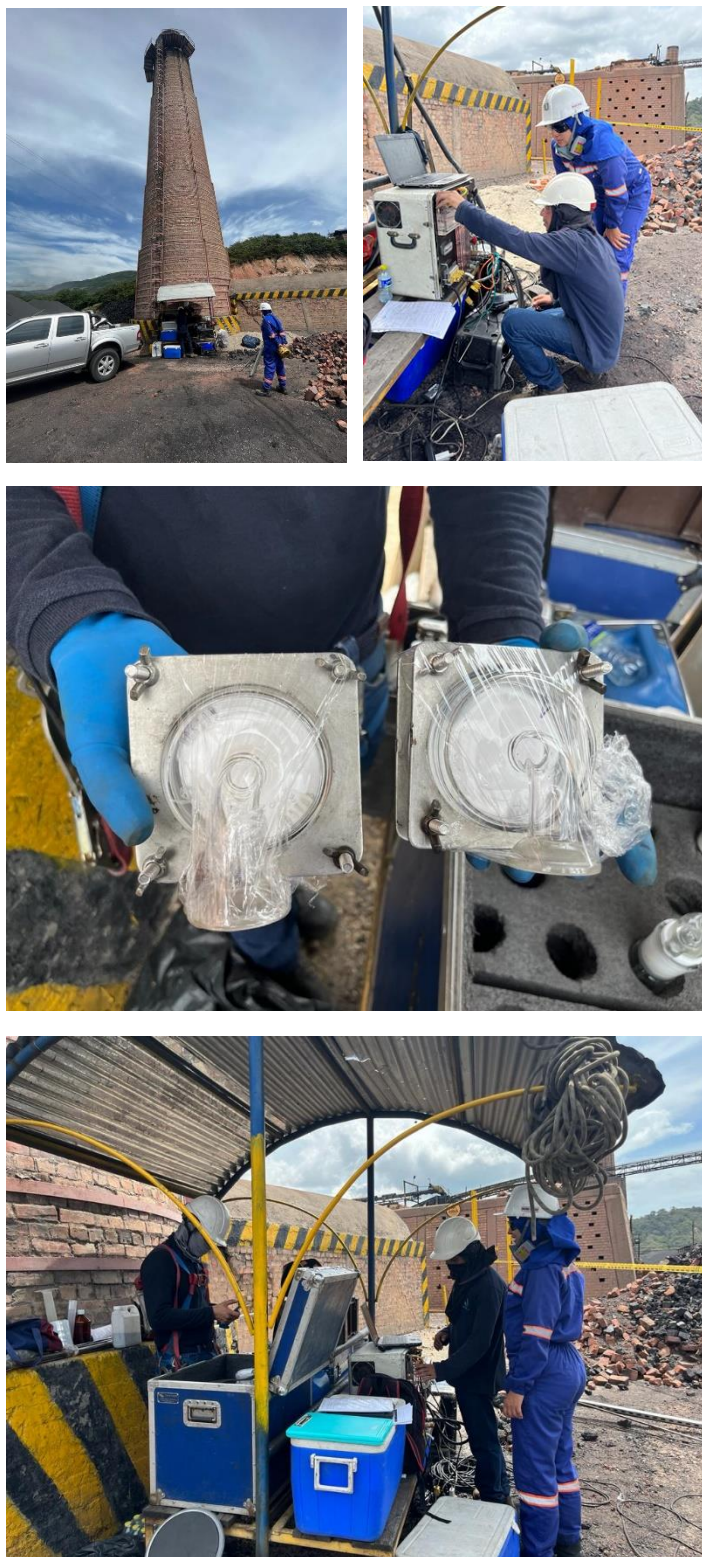
Figura 7. Evidencias del muestreo Isocinético
