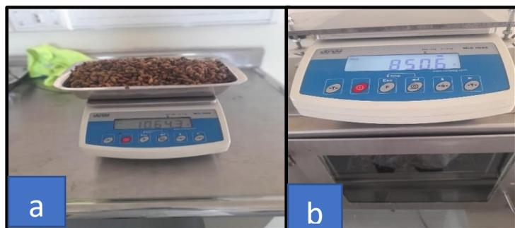
**Figura 9. Secado de las semillas del Neem. a) peso de las semillas. b) semillas en el horno.**
