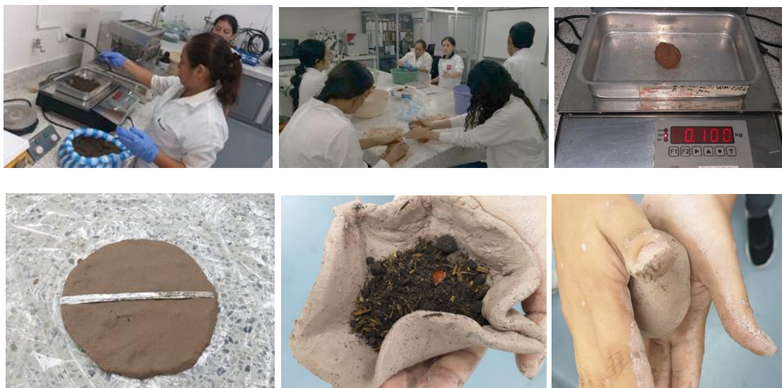
Figura 6 Actividades preliminares realizadas en laboratorio para determinar la proporción de arena y arcilla a evaluar por tratamiento, elaboración de bombas de arcilla
