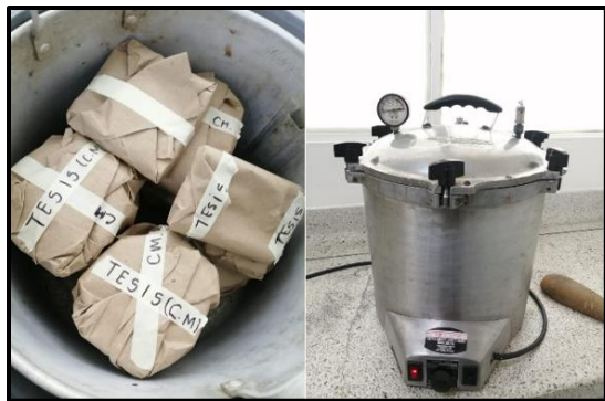
Figura 9. Esterilización del material
