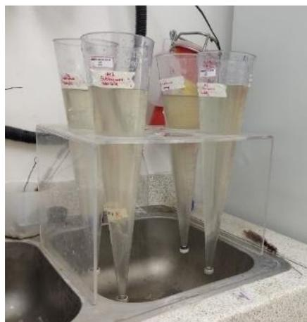
3. Se removió suavemente las paredes del cono con una varilla agitadora y se dejó sedimentar nuevamente por 15 minutos más.
