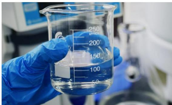
**Solución estándar de Hidrógeno Ftalato de Potasio (KHC<sub>8</sub>H<sub>4</sub>O<sub>4</sub>) 0,05N:** Se Pulverizó 15 gramos de Hidrógeno Ftalato de Potasio estándar primario ( $\pm 100$  mesh) y se secó a 120°C aproximadamente por 2 horas, se dejó enfriar en un desecador, pesar 10g  $\pm$  0,5g, se realizó el aforo de la solución en un balón de 1 litro y se almacenó en un recipiente de vidrio ámbar.
