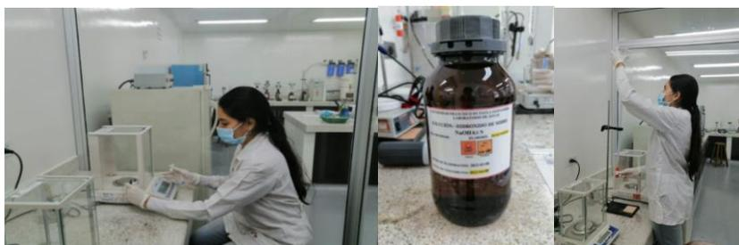
**Solución de Hidróxido de Sodio (NaOH) 0,02 N:** Se diluyó 200 mL de solución de NaOH 0,1N y se aforó a 1 litro. Se estandarizó esta solución titulando 7 mL de solución de Hidrógeno Ftalato de Potasio y se agregó 50 mL de agua libre de CO<sub>2</sub> (se le agregó 3 gotas de fenolftaleína) hasta pH 8,3. , es decir, hasta que la fenolftaleína viró de color. Se almacenó en un frasco de vidrio ámbar y se rotuló. Se estandarizó esta solución cada vez que se a realizaron análisis.
