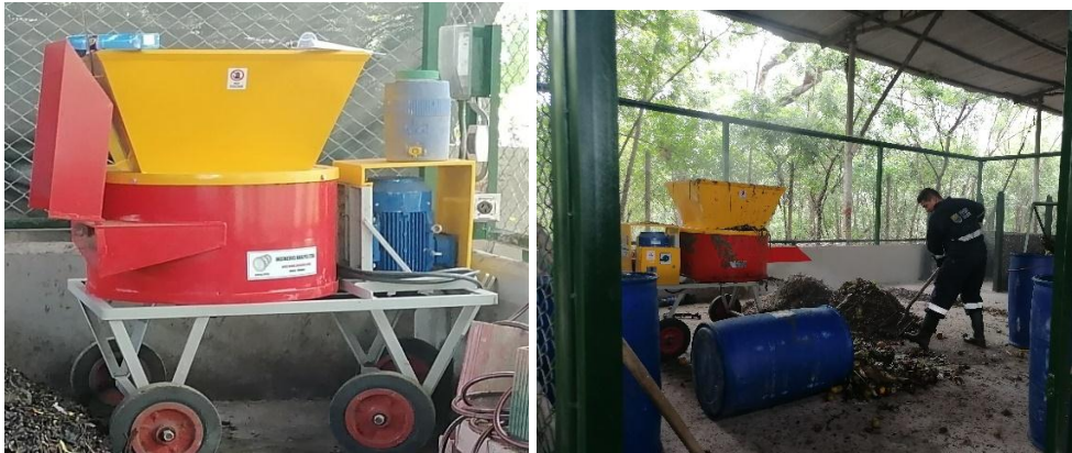
Figura 11. Maquina picadora y picado de material
