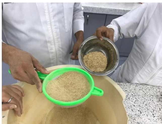
Figura 14. Tamizaje del bagazo molido
