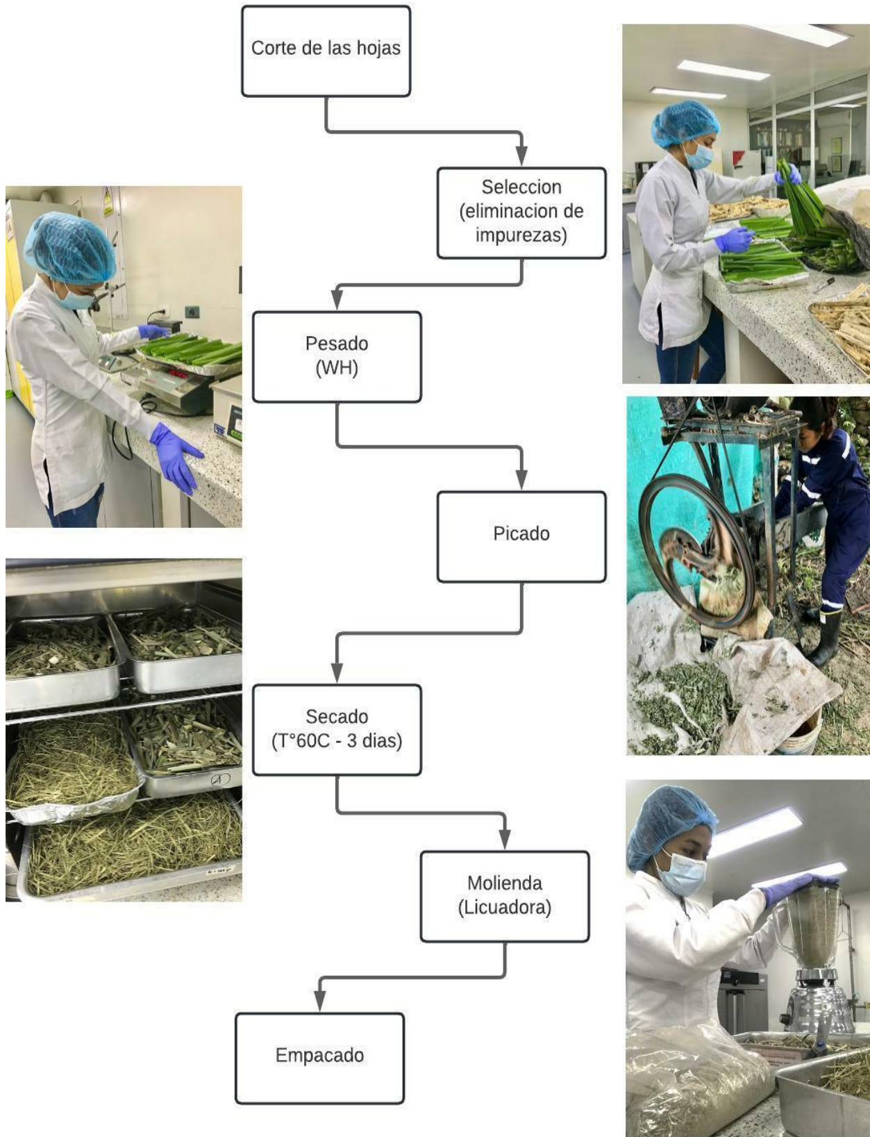
Figura 5. Flujo de procesos de la harina del forraje de caña
