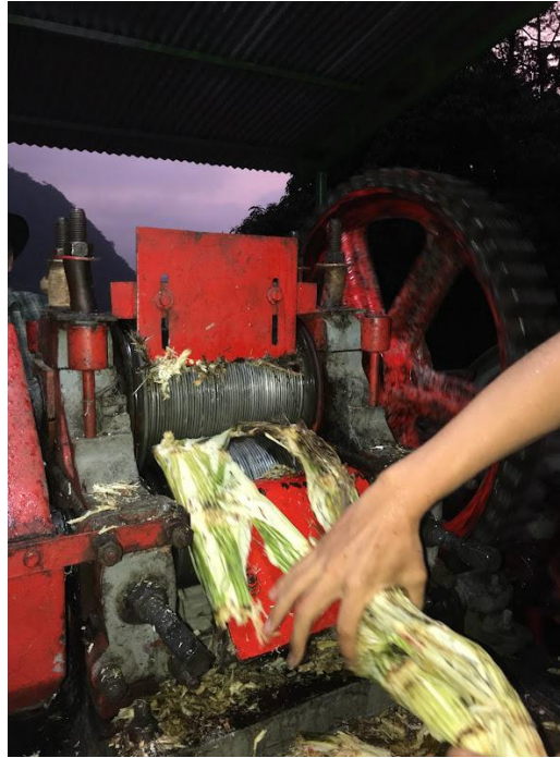
Figura 3. Molienda de la caña, obtención del bagazo
