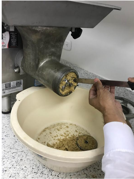
Figura 11. Taponamiento del molino
