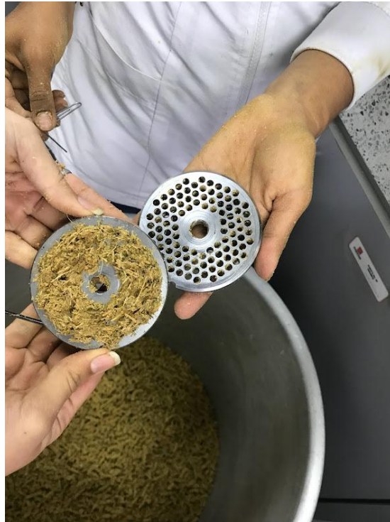
Figura 11. Taponamiento del molino
