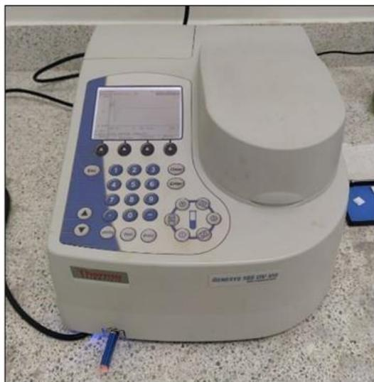
**Figura 13.** Espectrómetro ultravioleta/visible GENESYS 10S UV-VIS. Fuente: laboratorio de calidad ambiental Campos Elíseos.
