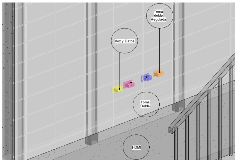
Figura 40. Modelo 4d detalle tomacorrientes, tomas hdmi, voz y datos.
