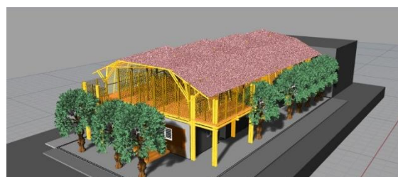
Láminas de guadua sobre la estructura de cubierta Y manto y teja asfáltica para la cubierta.
