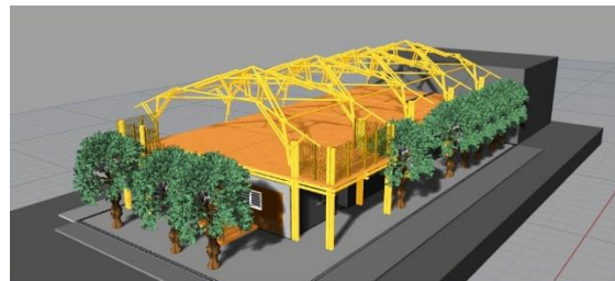
Estructura de entramado en guadua, base soporte para la cubierta
