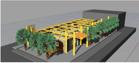
Estructura de entepiso y columnas de soporte en guadua. / Pequeña terraza o balcón en guadua mismo sistema en guadua.
