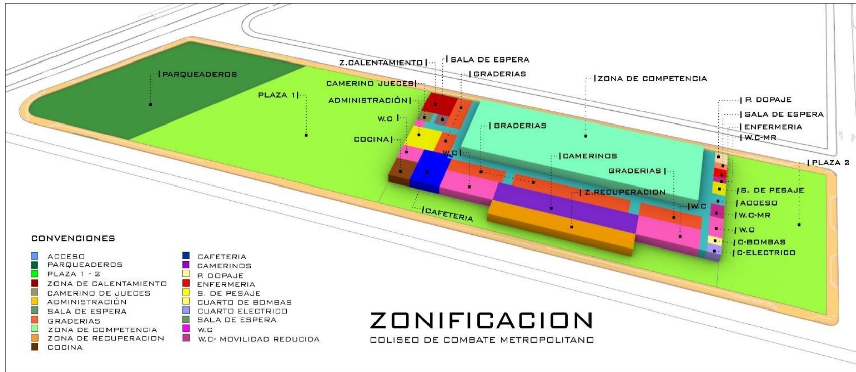
Figura 52. Esquema básico de zonificación
