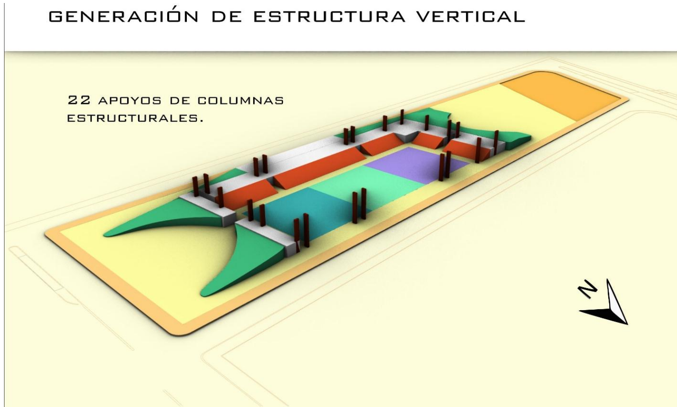
Figura 64. Generación de estructura vertical
