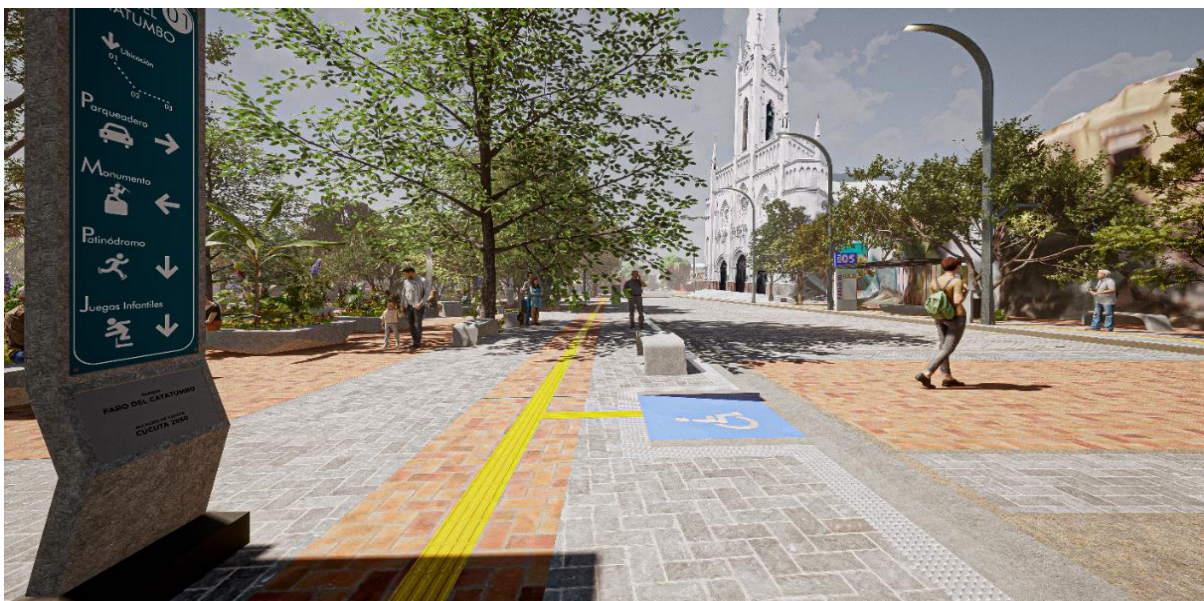
Figura 103. Detalle urbanístico, señaléticas, rampas, pasos peatonales, luminarias, bancas xiora y bancas jardinera (kiiden), corredor podó táctil, juego de texturas, adoquina miento vial, Basílica Menor de San Luis.
