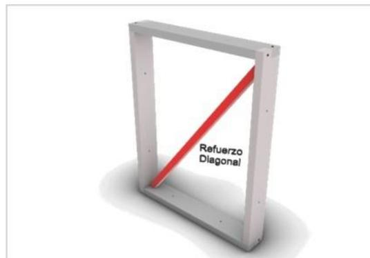
*Figura 130 Instalación del Refuerzo Diagonal*
