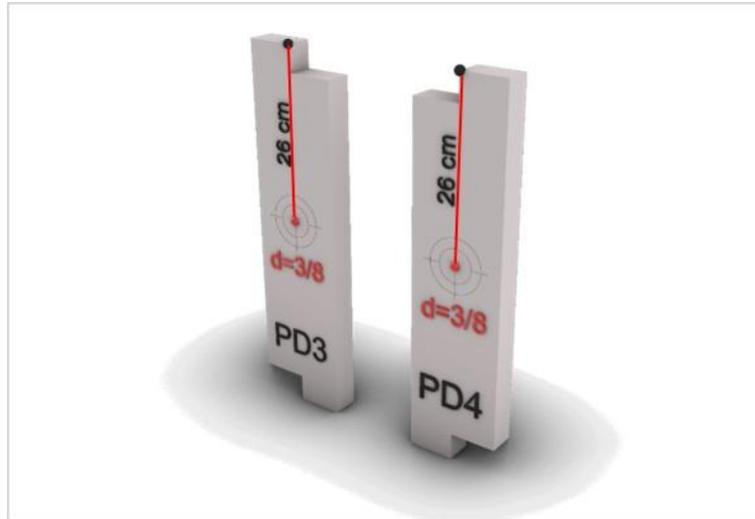
Figura 147 perforación del pie derechos del panel de ventilación
