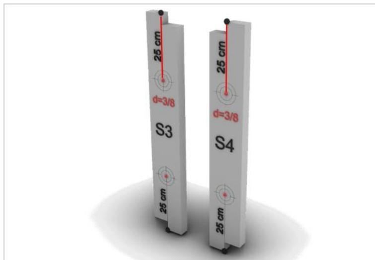
Figura 148 Perforación de las soleras del panel de ventilación
