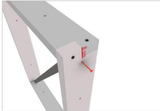
***Figura 131*** *instalación del Refuerzo Diagonal paso*
