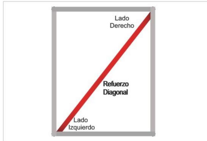
***Figura 127 Posición del Refuerzo Diagonal***
