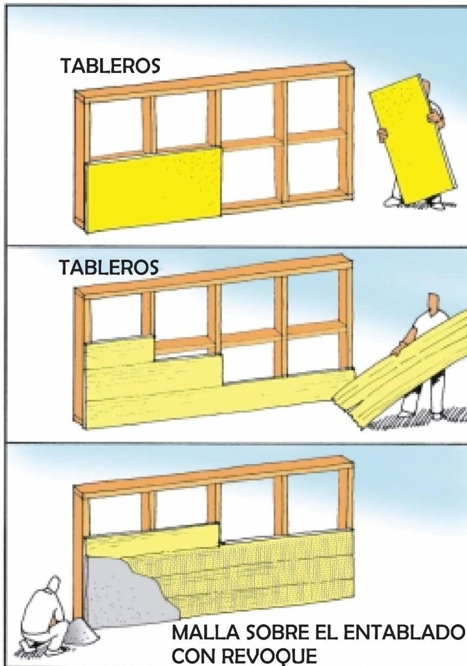
*Figura 61 Recubrimiento muro de bahareque encementado con riostras horizontales*
