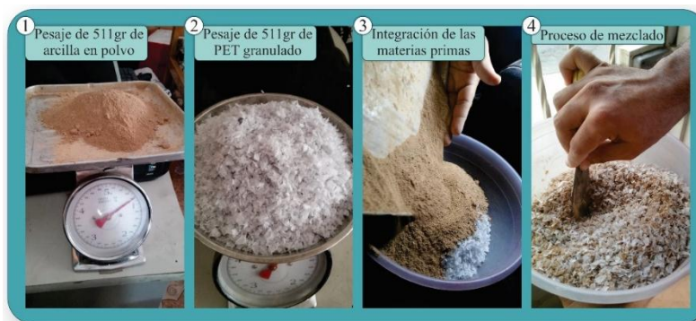
Figura 57. Preparación de la pasta prueba N.º 1.1
