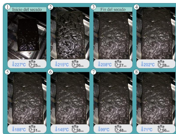
Figura 219. Proceso de secado prueba anilina vegetal
