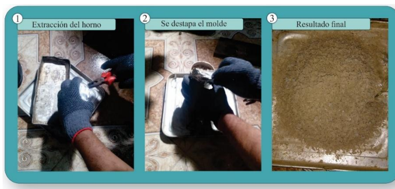
Figura 60. Proceso de desmoldado prueba N. ° 1.1
