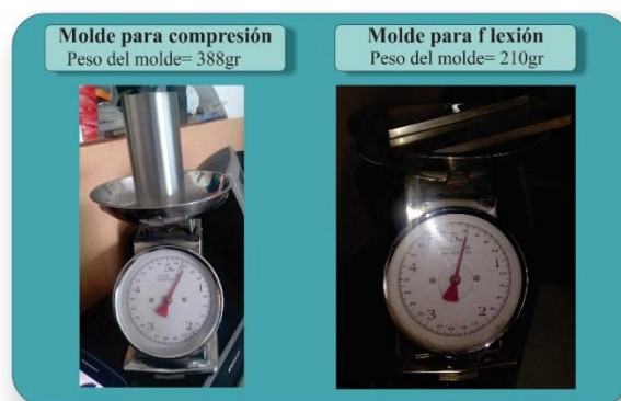
Figura 53. Peso de los moldes vacíos para flexión y compresión (peso tara)
