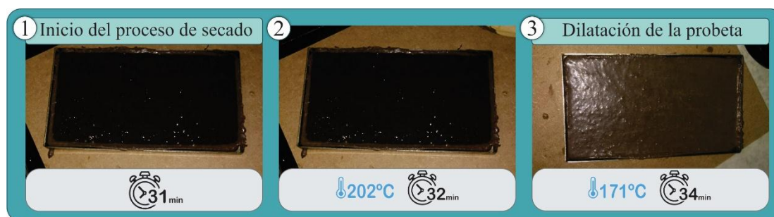
Figura 97. Proceso de secado prueba N. ° 6.1
