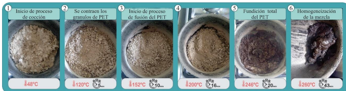
Figura 111. Proceso de cocción prueba N.º 8.2
