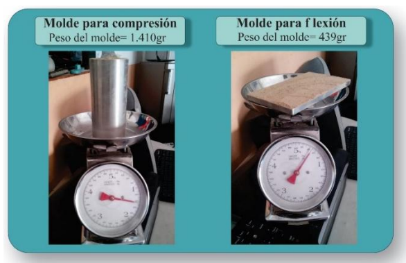
Figura 54. Pesaje de los moldes con polvo de arcilla, para flexión y compresión (peso bruto)
