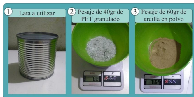
Figura 81. Preparación de la pasta prueba N.º 4
