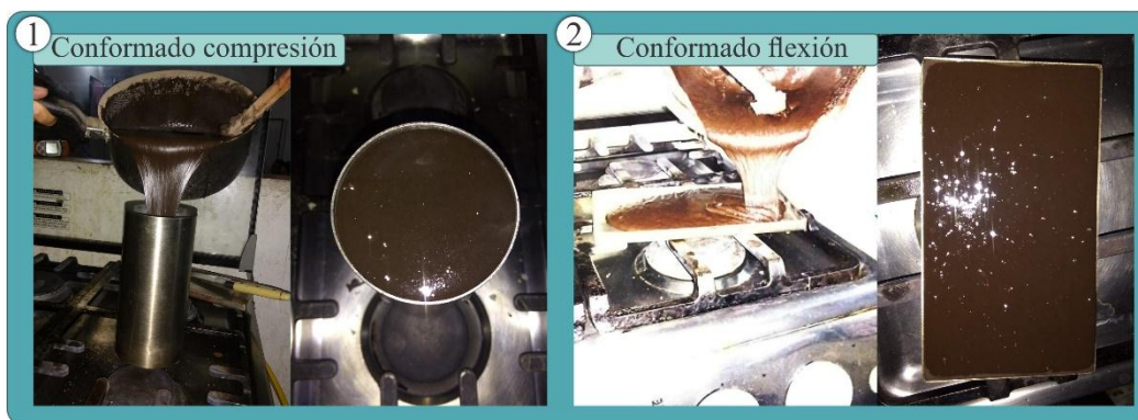
Figura 180. Proceso de conformado de probetas
