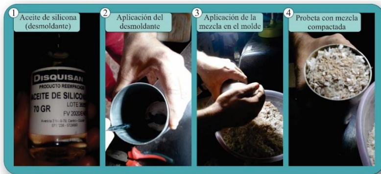
Figura 58. Proceso de conformado prueba N. ° 1.1
