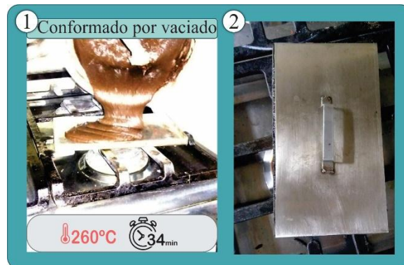
Figura 116. Proceso de conformado prueba N. ° 8.3
