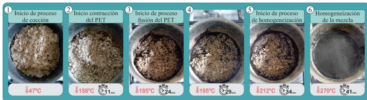
Figura 119. Proceso de cocción prueba N.º 8.4
