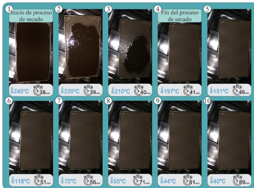
Figura 102. Proceso de secado prueba N. ° 7.1
