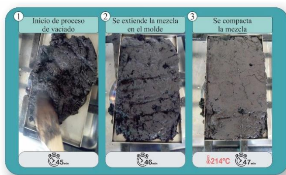
Figura 112. Proceso de conformado prueba N.º 8.2
