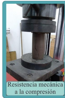
Figura 176. Ensayo de la resistencia mecánica a la compresión
