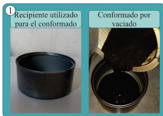
Figura 83. Conformado por vaciado prueba N.º 4
