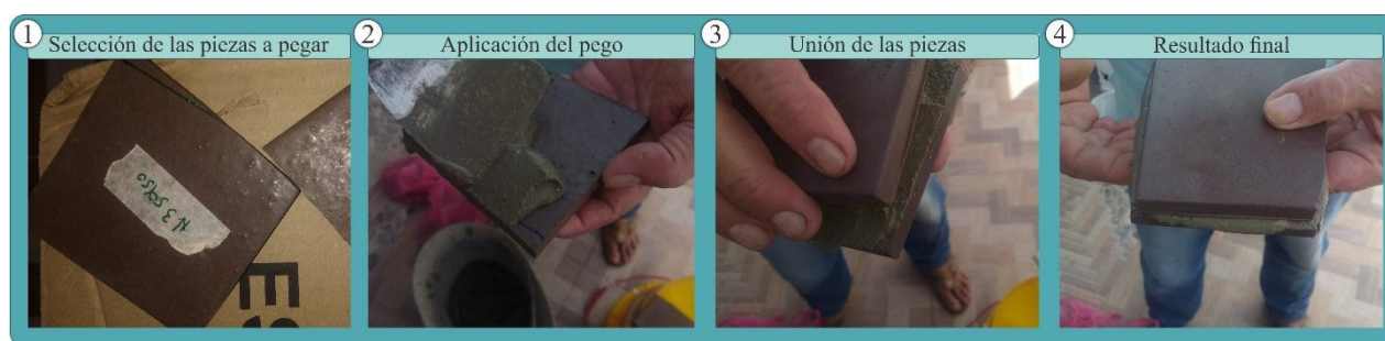
Figura 225. Prueba de pega con cemento
