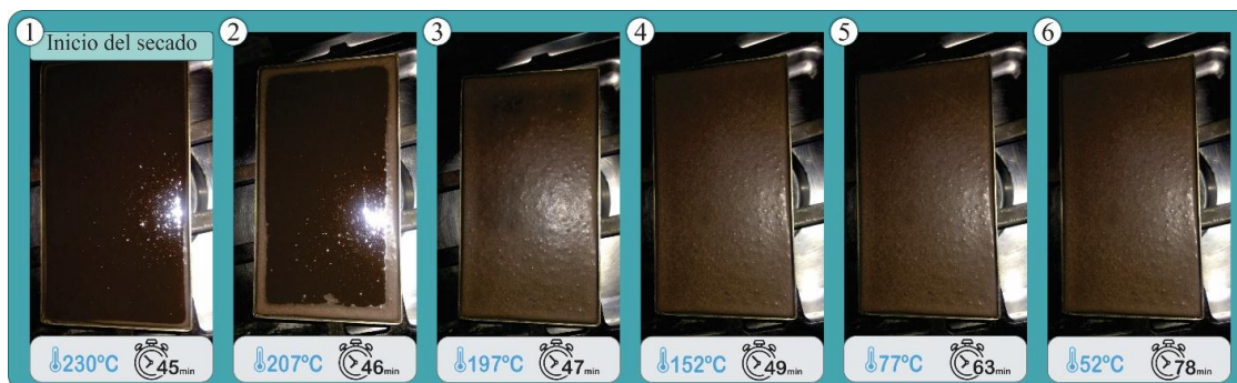
Figura 134. Proceso de secado prueba N. ° 10.2
