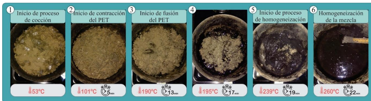
Figura 149. Proceso de cocción prueba N.º 13.1
