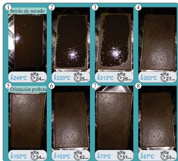
Figura 150. Proceso de secado prueba N. ° 13.1
