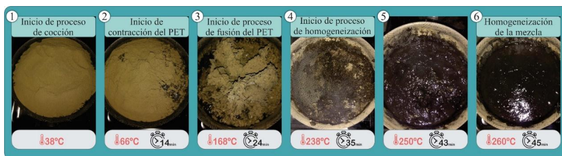
Figura 127. Proceso de cocción prueba N. ° 9.1
