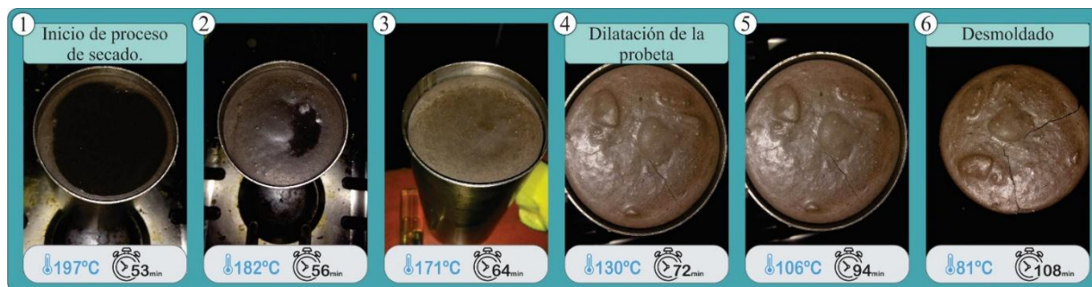
Figura 155. Proceso de secado prueba N. ° 14.1
