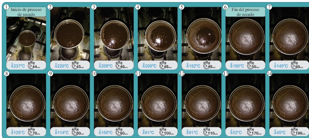
Figura 137. Proceso de secado prueba N.º 11.1
