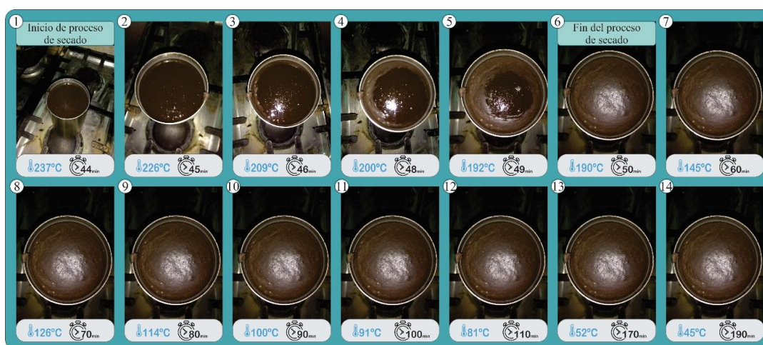
Figura 131. Proceso de secado prueba N. ° 10.1
