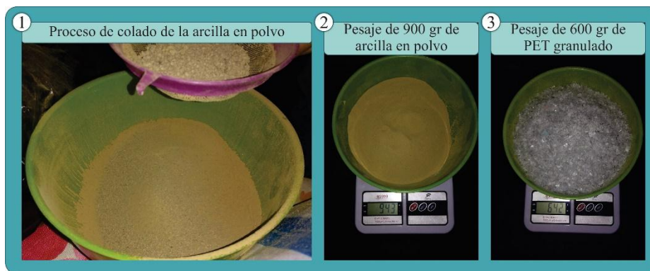
Figura 104. Preparación de la pasta prueba N.º 7.2
