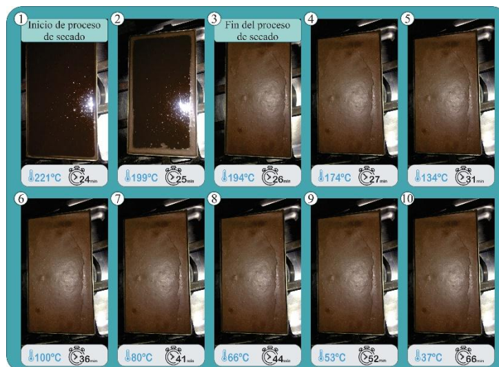
Figura 147. Proceso de secado prueba N. ° 12.2
