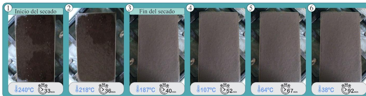
Figura 211. Proceso de secado prueba Pet verde
