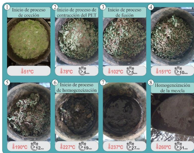
Figura 210. Proceso de cocción prueba Pet verde
