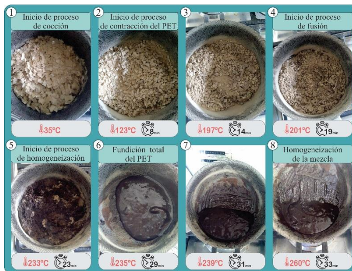
Figura 115. Proceso de cocción prueba N.º 8.3
