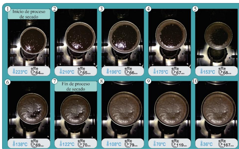
Figura 161. Proceso de secado prueba N.º 15.1
