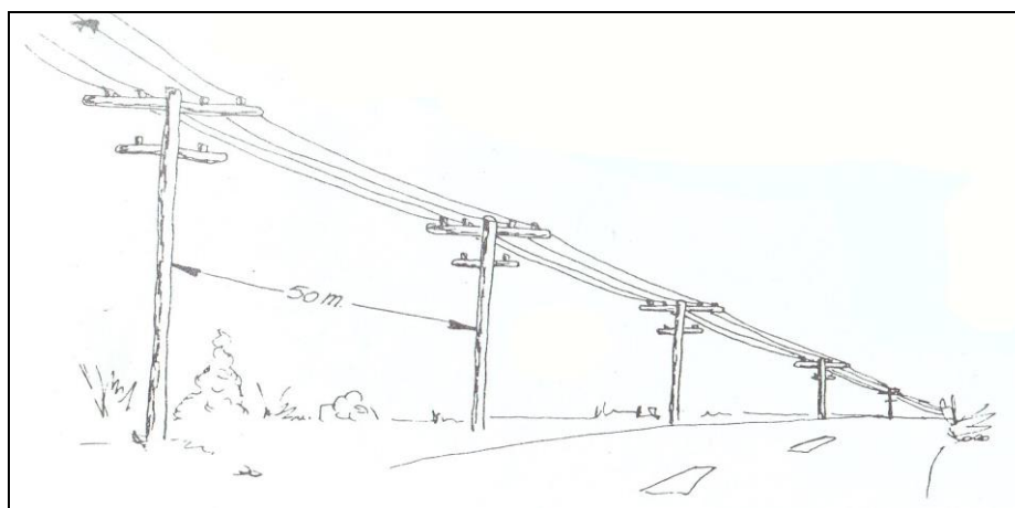
Figura 6. Distancias entre postes de baja tensión.
