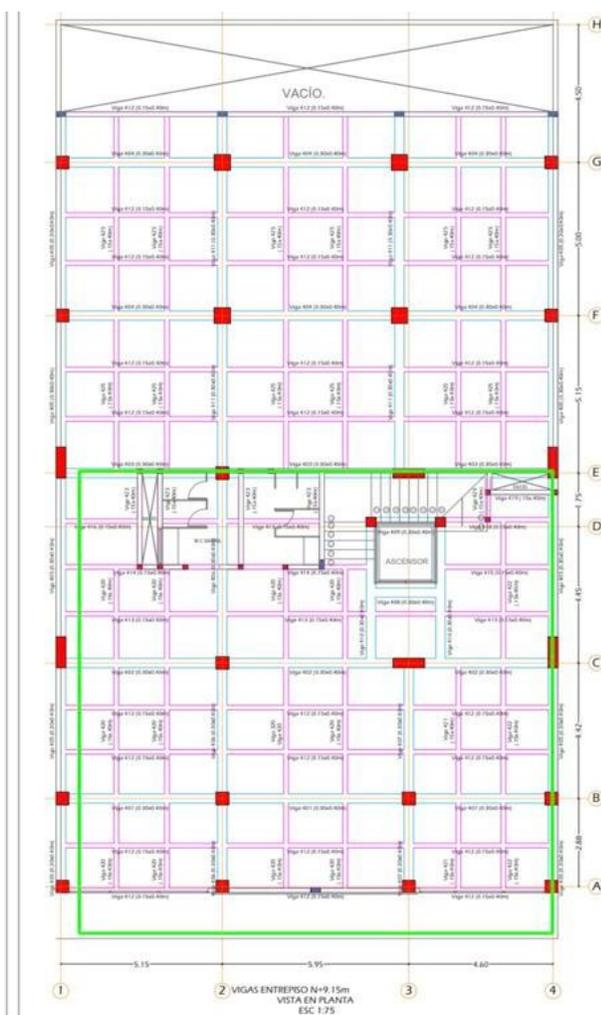
Ilustración 47. Sección señalada de fundida de placa metaldeck Edificio Wiedii
