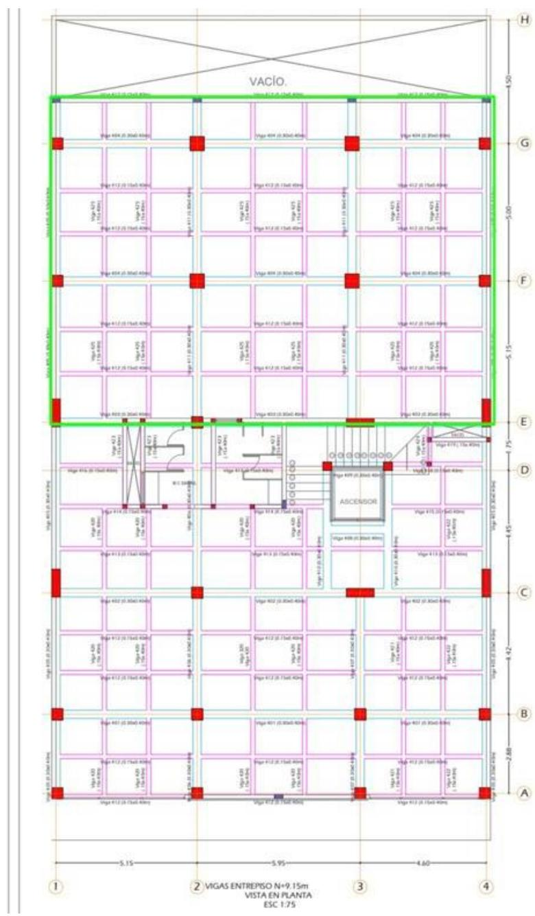
Ilustración 46. Segundo tramo de instalación de Metaldeck nivel 4.
