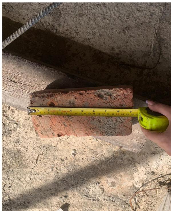
*Ilustración 66. Bloque de ladrillo de 23cm*
