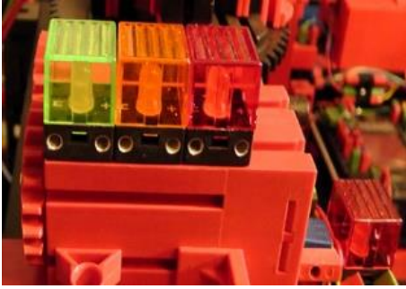
Figura 20. Indicador de estado de la fábrica.
