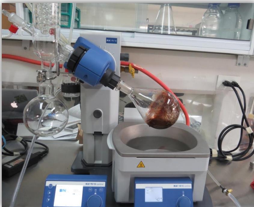
Figura 5. Rotavapor, equipo de concentración a presión reducida. Fotografía: Abril, F. , 2019.
