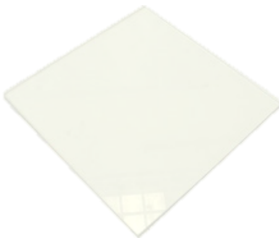
Ilustración 3. Placa e vidrio para la realización del ensayo de límite plástico.
