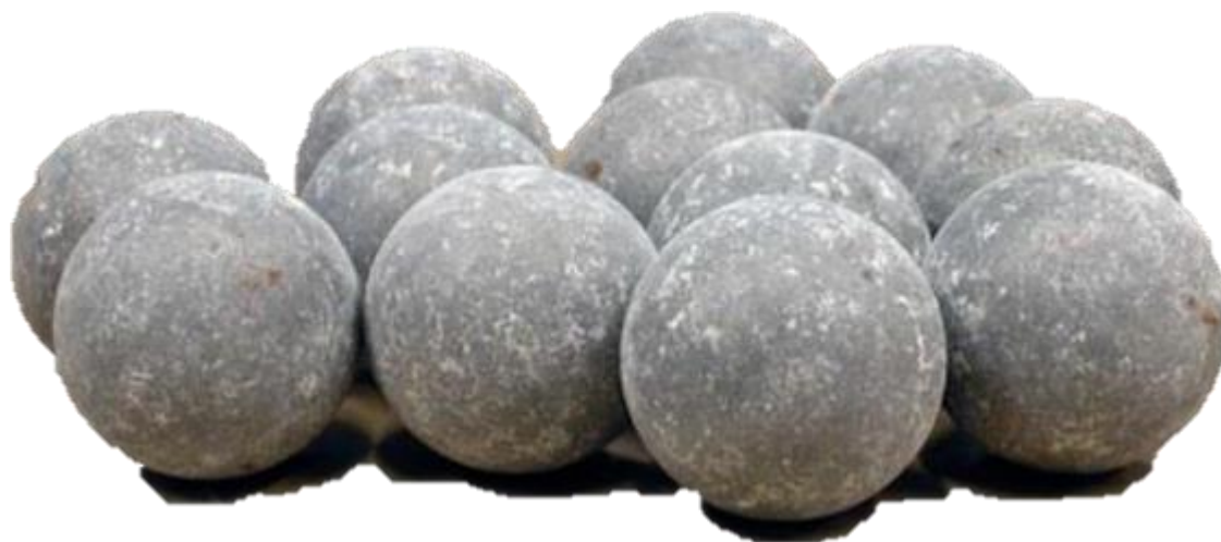
Ilustración 2. Esferas de desgaste para la máquina de los Ángeles.
