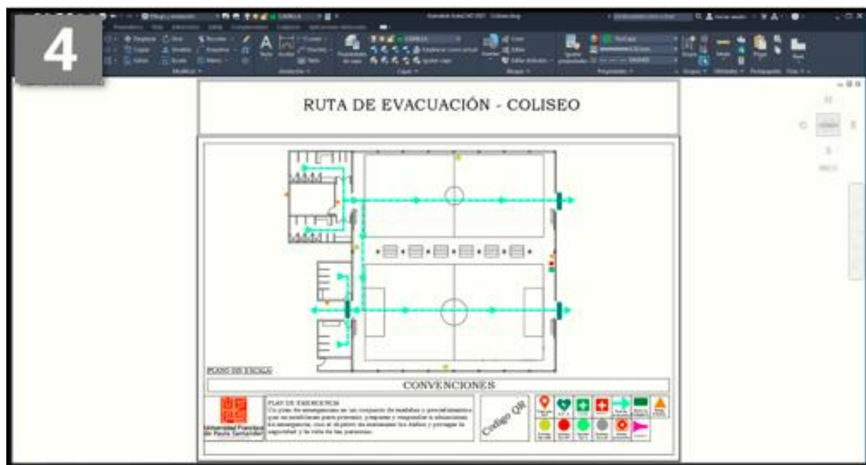
Ilustración 29. Plano digitalizado con la ubicación de las rutas de evacuación y los recursos de atención de emergencias. Fuente: elaboración propia.
