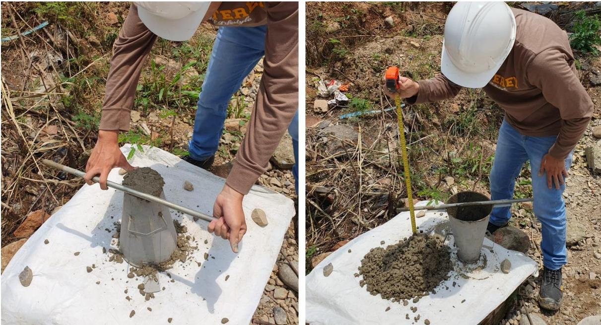
*Ilustración 42. Prueba de asentamiento. Fuente: Elaboración propia.*
