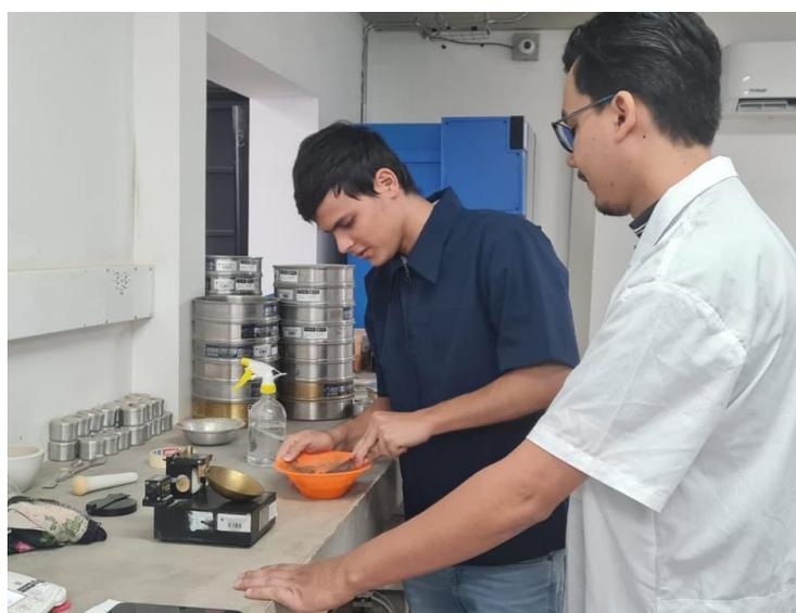
*Ilustración 36. Practicante realizando laboratorio de límite líquido y plástico bajo asesoría profesional. Fuente: Laboratorio LABMAC, SENA.*
