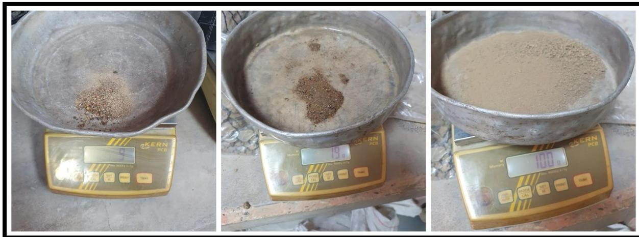
*Ilustración 32. Peso seco, lavado y lavado seco. Fuente: Elaboración propia.*
