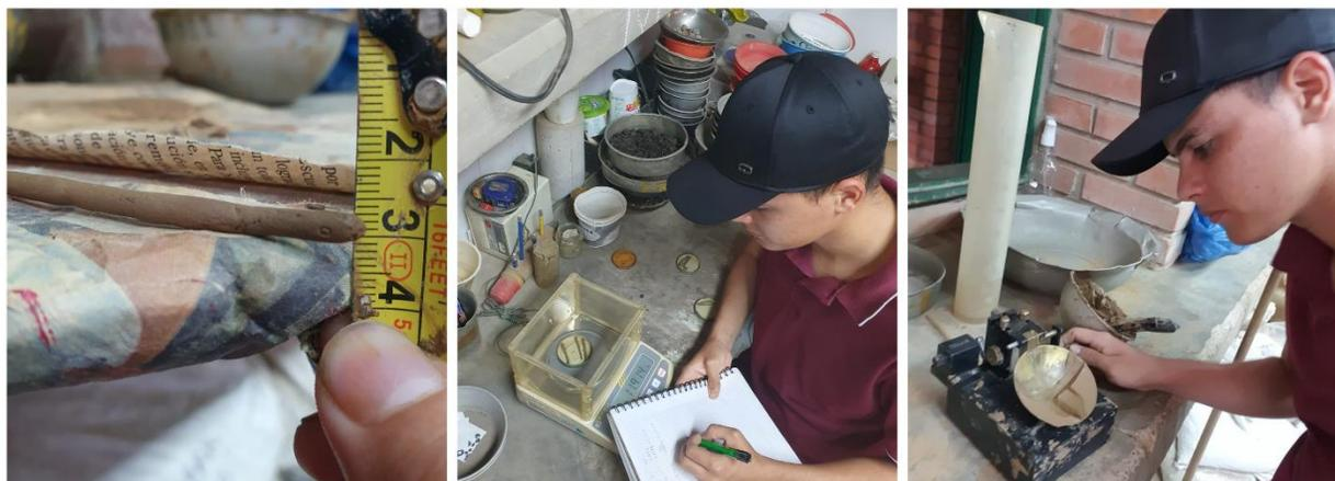
*Ilustración 33. Realización del laboratorio, límites de Atterberg. Fuente: Elaboración propia.*
