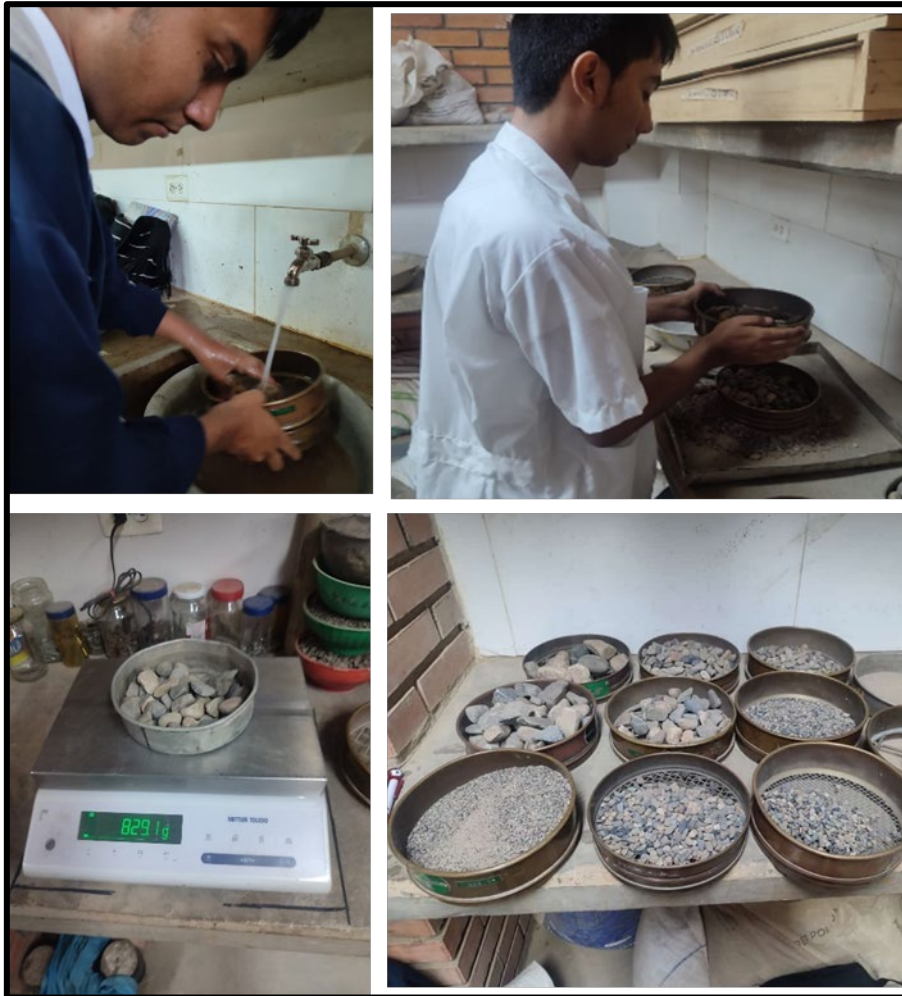
Ilustración 68. Ensayo de Granulometría para materia de Sub-Base y Base granular.
