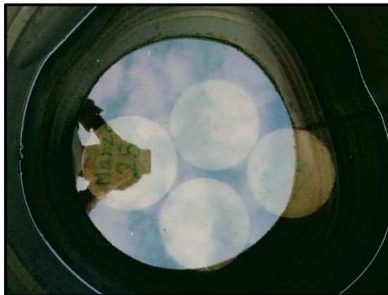
Ilustración 59. Cilindros suministrados en agua.
