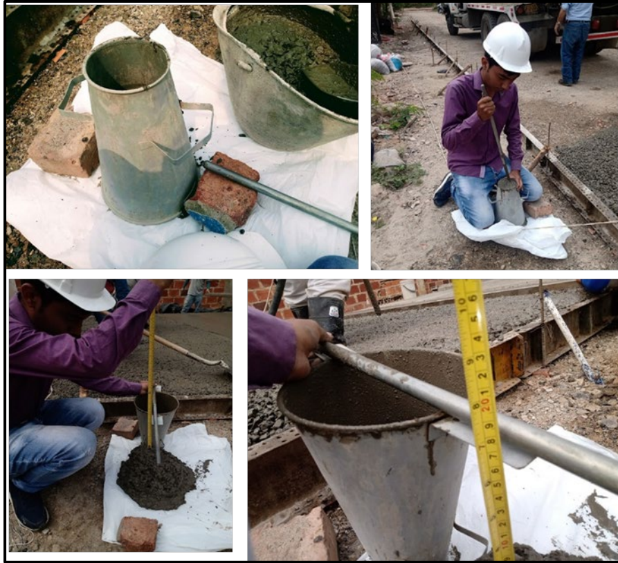
Ilustración 24. Ensayo del Slump.
