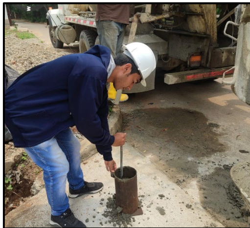
Ilustración 26. Cilindros de concreto para Ensayo de Fuerza a la compresión
