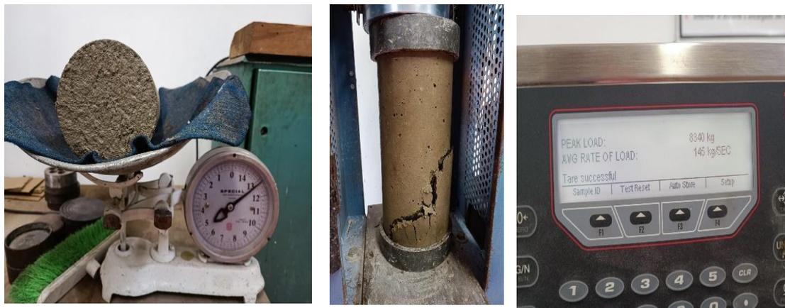
**Figura 3. Ensayo de compresión de concreto**
