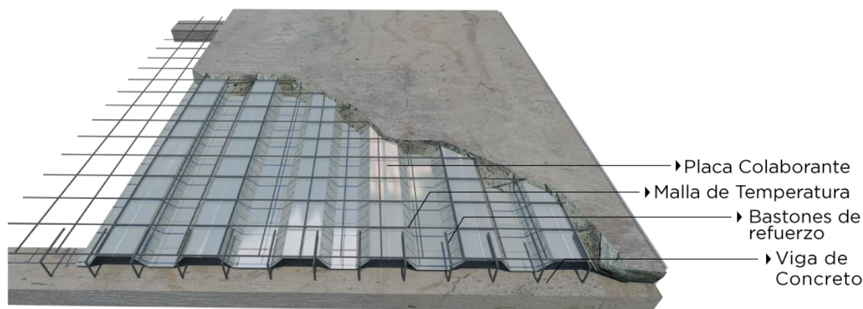
Figura 41. Modelo de placa en metaldeck.
