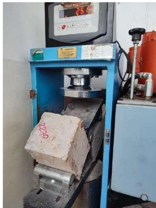
Figura 82. Rotura de vigueta Fuente: practicante
