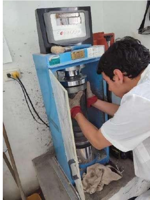
Figura 74. Ingreso de cilindro a la máquina de compresión Fuente: practicante
