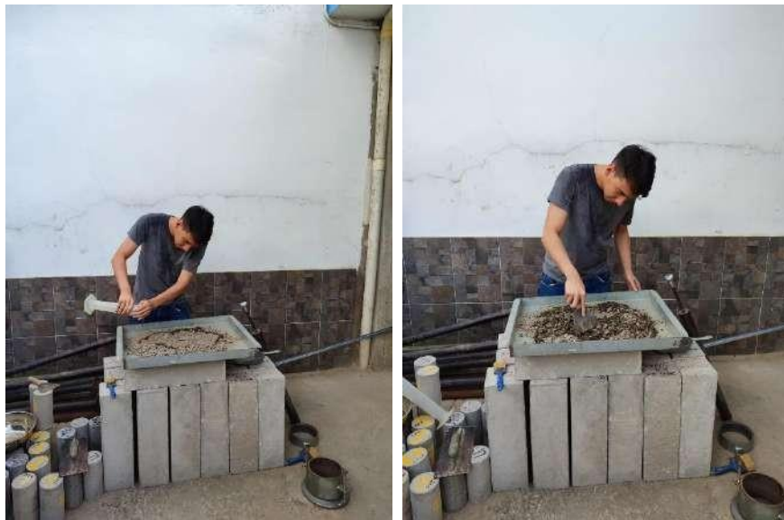
Figura 47 y 48. Añadir cantidad de agua y mezclar Fuente: practicante
