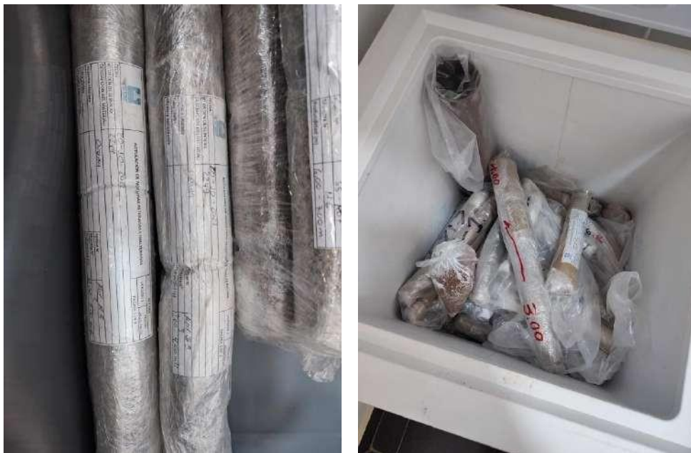
Figura 86 y 87. Guardar muestras de sondeos en la nevera Fuente: información
