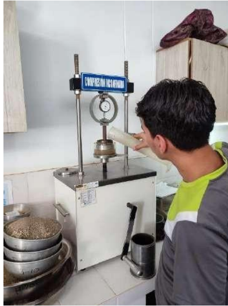
Figura 38. Agregar agua hasta el borde de la caja Fuente: practicante
