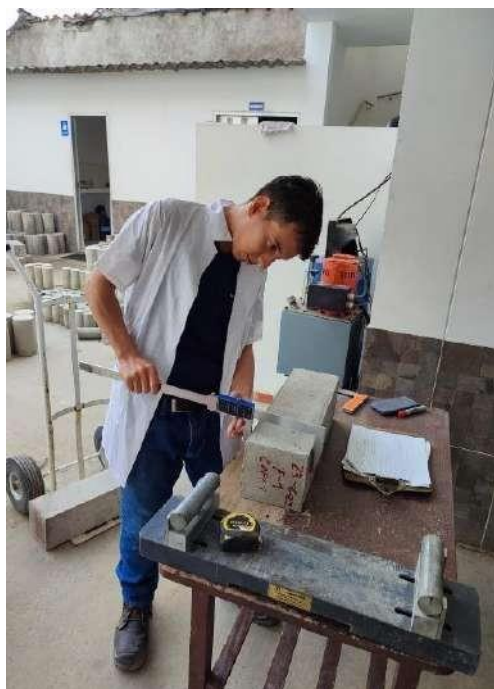
Figura 77. Tomar alturas y anchos Fuente: practicante
