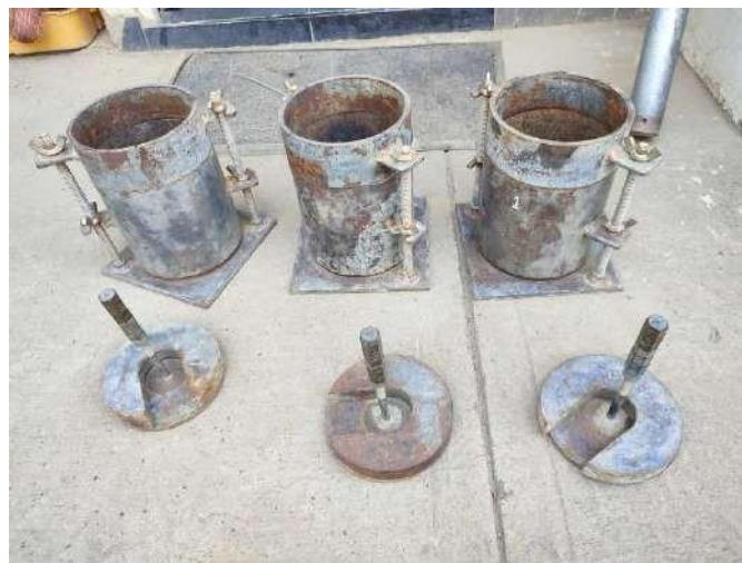
Figura 51. Moldes metálicos Fuente: practicante
