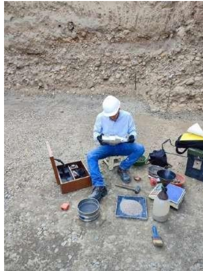
Figura 95. Agitar hasta llegar a la humedad natural del material Fuente: practicante
