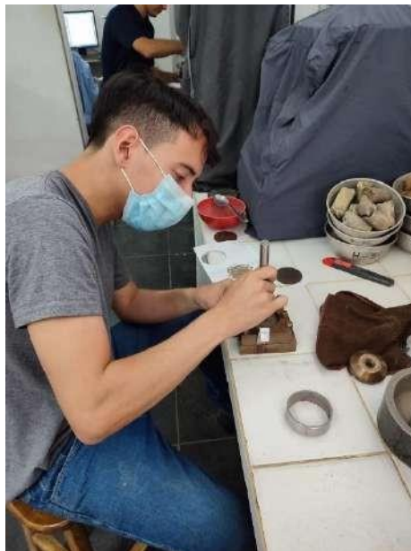
Figura 41. Insertar la muestra dentro de la caja de corte Fuente: practicante
