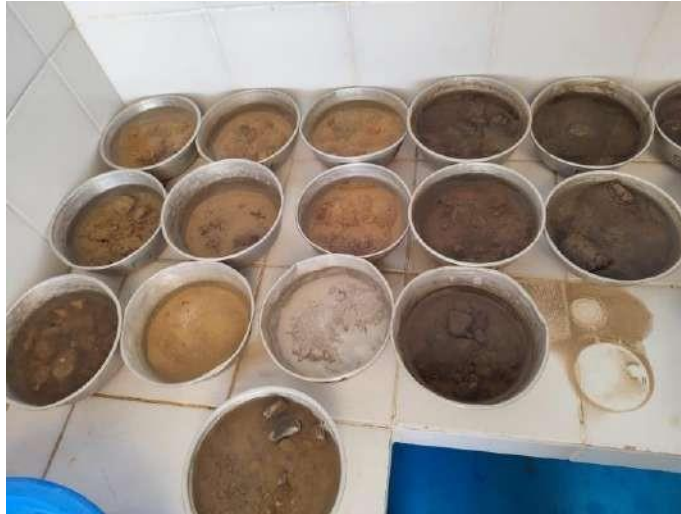
Figura 7. Remojar las muestras Fuente. practicante
