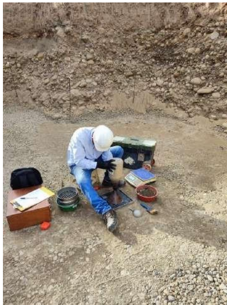
Figura 92. Colocar el cono y arena sobre la placa base boca abajo Fuente: practicante
