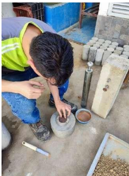
Figura 33. Añadir primera capa al anillo metálico Fuente: practicante
