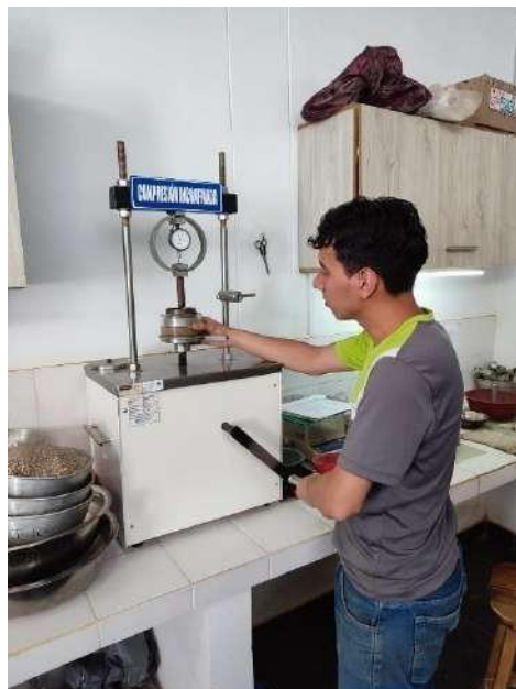
Figura 37. Montar la caja Fuente: practicante
