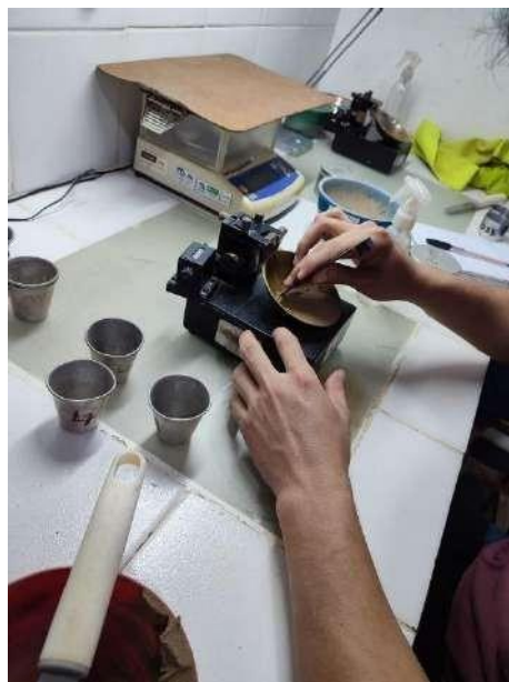
Figura 18. Pasar el Ranurador por el material Fuente: practicante
