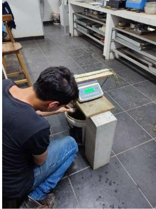
Figura 40. Sumergir la muestra Fuente: practicante
