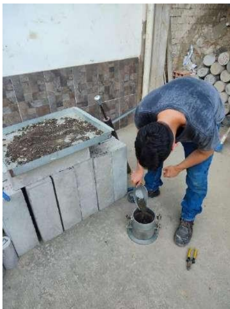
Figura 49. Vaciar la primera capa de material en el molde Fuente: practicante
