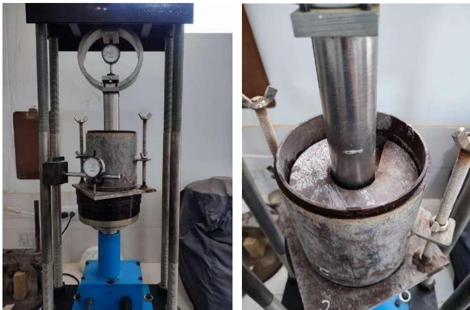
Figura 58 y 59. Colocar molde y pesa en el molde Fuente: practicante
