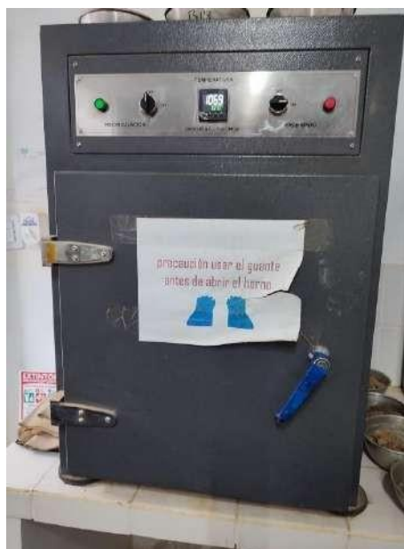
Figura 5. Ingresar las muestras al horno Fuente: practicante
