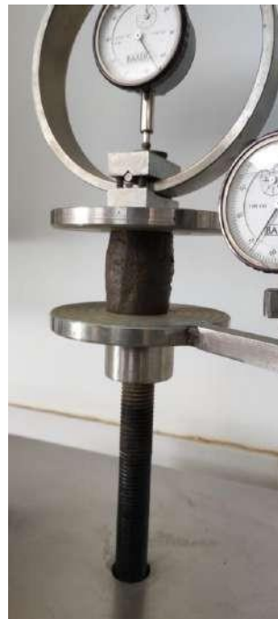
Figura 30. Fallar la muestra Fuente: practicante
