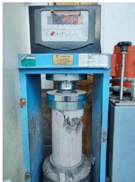
Figura 75. Identificar el tipo de falla Fuente: practicante
