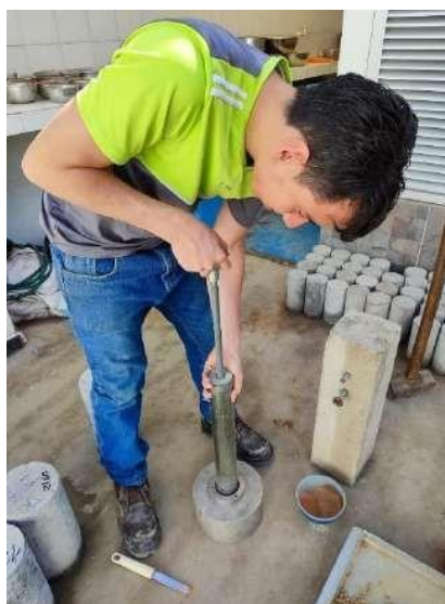
Figura 34. Aplicar golpes Fuente: practicante
