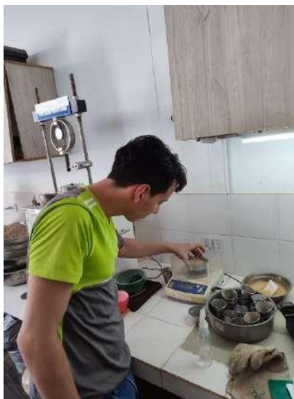
Figura 35. Tomar peso de la muestra Fuente: practicante
