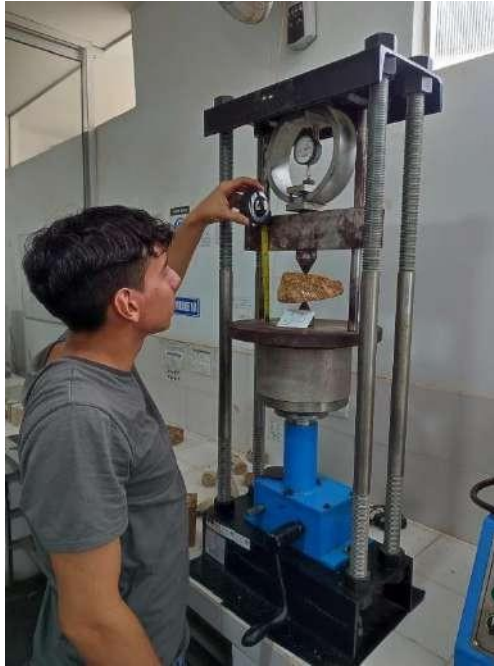
Figura 63. Distancia entre puntas Fuente: practicante
