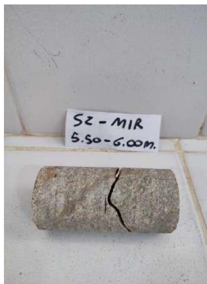
Figura 65 y 66. Rotura de muestra Fuente: practicante
