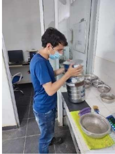
Figura 10. Tamizaje de material Fuente. practicante
