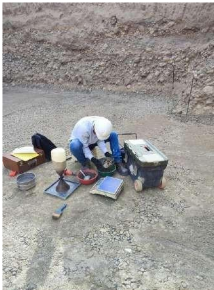
Figura 93. Pesar retenido del Tamiz No \frac{3}{4} Fuente: practicante
