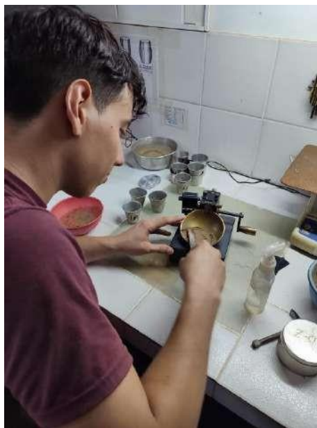
Figura 17. Enrasar material sobre la cazuela Fuente: practicante
