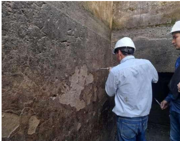
Figura 96. Aplicar el martillo dentro del área Fuente: practicante
