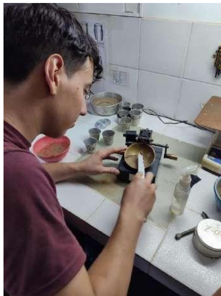
Figura 16. Agregar material a la cazuela Fuente: practicante
