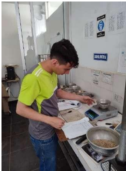
Figura 27. Tomar peso muestra húmeda Fuente: practicante
