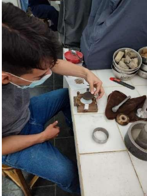
Figura 42. Colocación de piedra porosa fuente: practicante
