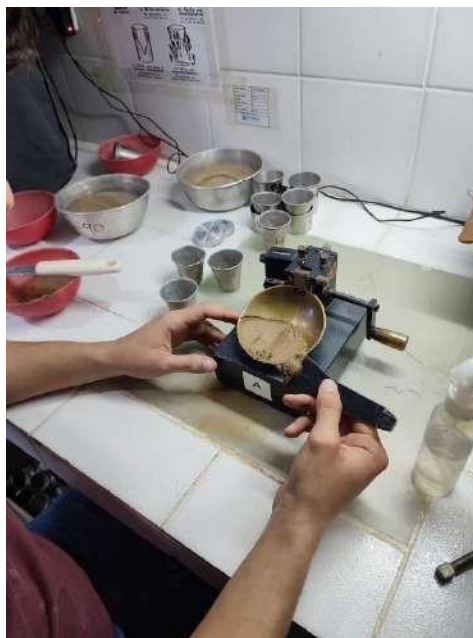
Figura 20. Pasar el material retirado al recipiente Fuente: practicante
