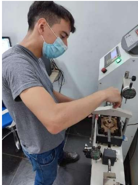
Figura 43. Insertar caja de corte en el aparato de corte fuente: practicante
