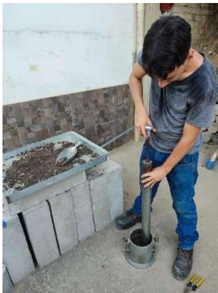
Figura 49. Aplicar golpes a la muestra Fuente: practicante
