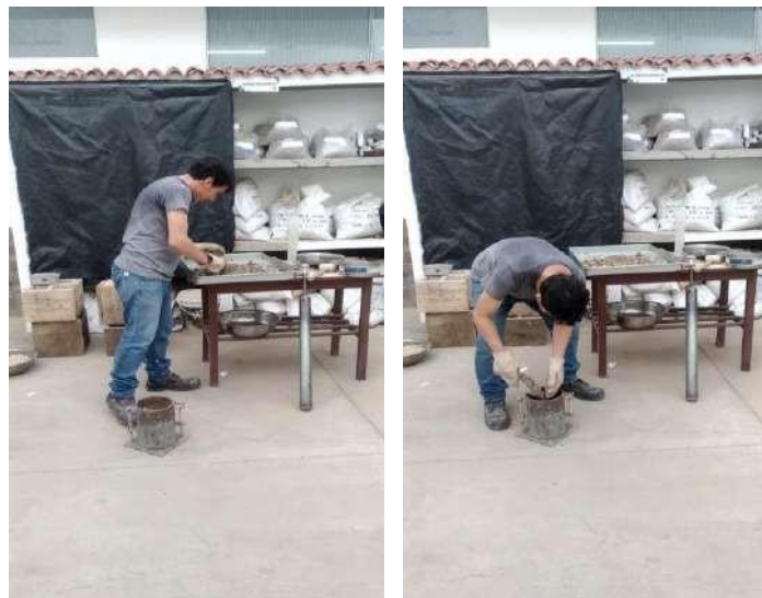
Figura 52 y 53. Añadir la primera capa de material al molde Fuente: practicante
