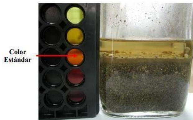
Figura 71. Observación color de la muestra Fuente: practicante
