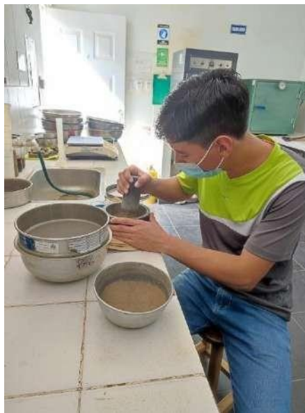
Figura 14. Disgregación de material Tamiz No 40 Fuente: practicante
