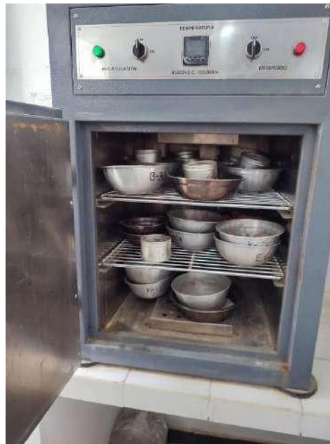
Figura 45. Ingresar humedad natural al horno Fuente: practicante
