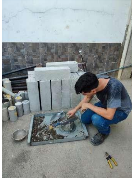
Figura 50. Enrasar al borde del molde Fuente: practicante
