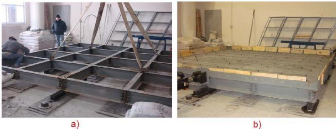
**Ilustración 9.** a) Montaje de la estructura de la mesa vibratoria de 5x5m, b) mesa vibratoria finalmente construida. *Álvarez, R. J (2008).*
