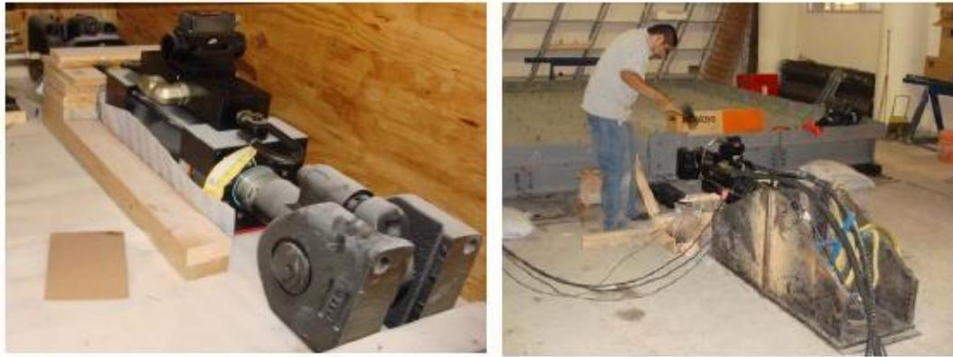
**Ilustración 7.** Actuator hidráulico y conexión del mismo a la mesa vibratoria. *Álvarez, R. J (2008).*
