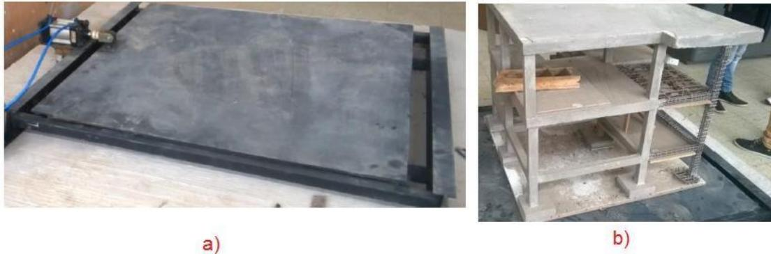
**Ilustración 17.** a) Mesa vibratoria, b) modelo a escala empotrado en mesa vibratoria. **Romero, N. (2016).**
