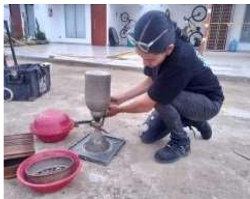
Ilustración 11. masa unitaria suelta y compacta del agregado fino
