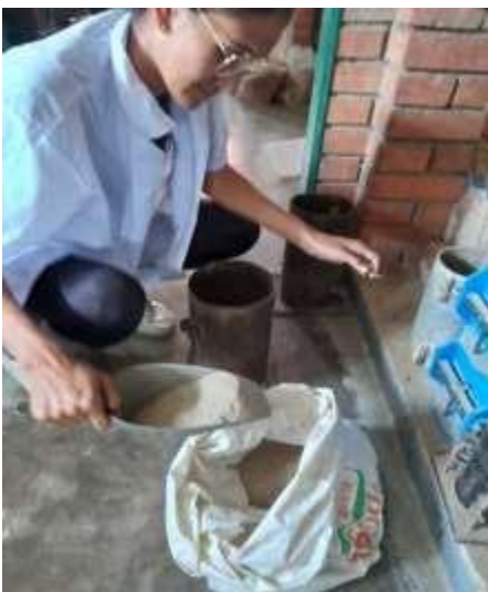
Ilustración 11. masa unitaria suelta y compacta del agregado fino
