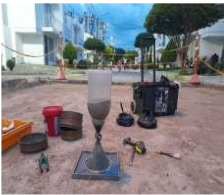
Ilustración 12. Densidad método cono de arena
