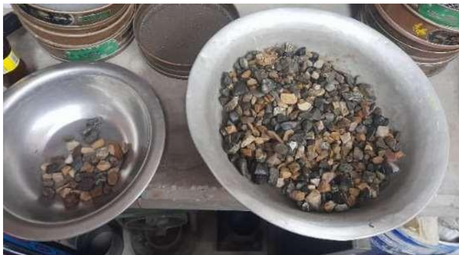
Ilustración 6. Gravedad específica y absorción del agregado grueso
