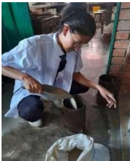
Ilustración 11. masa unitaria suelta y compacta del agregado fino
