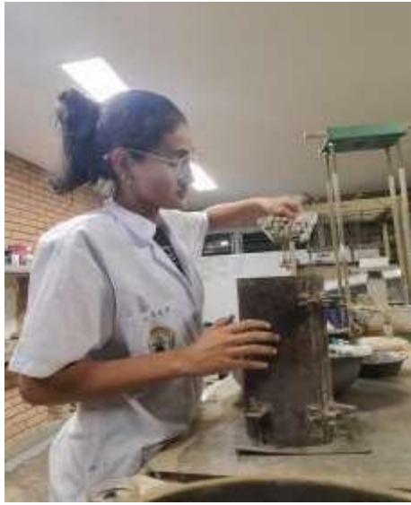
Ilustración 10. masa unitaria suelta y compacta del agregado grueso
