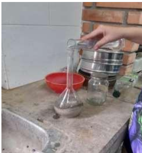
Ilustración 7. Gravedad específica y absorción del agregado fino
