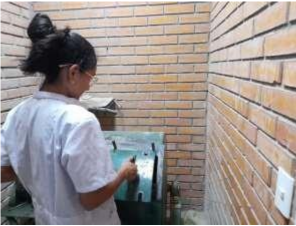
Ilustración 13. Desgaste máquina de los ángeles
