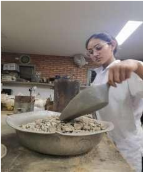
Ilustración 10. masa unitaria suelta y compacta del agregado grueso
