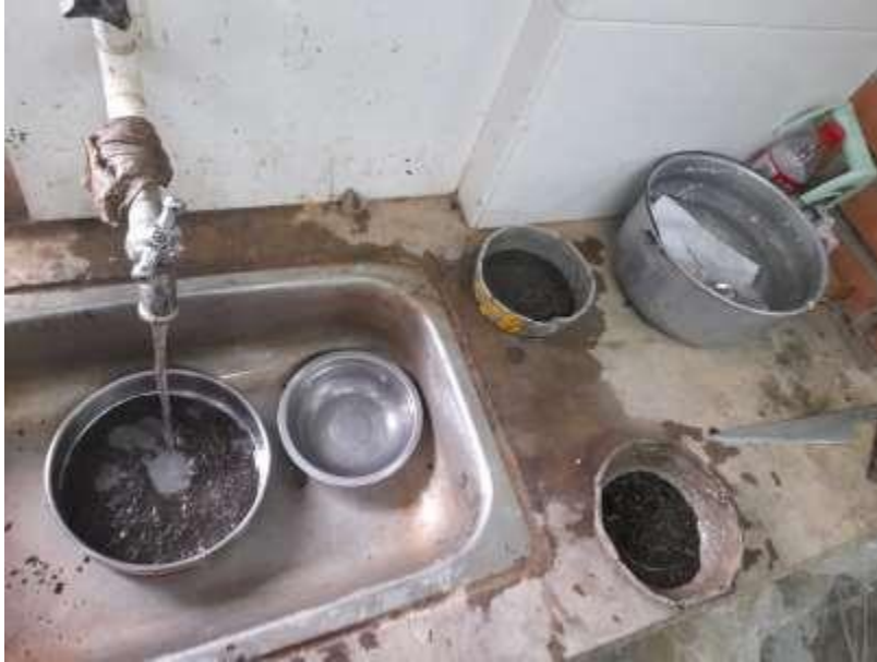
Ilustración 2. Lavado por tamiz n°200
