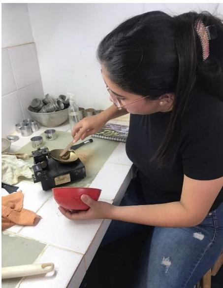
**Figura 8. Se extiende una porción del material**
