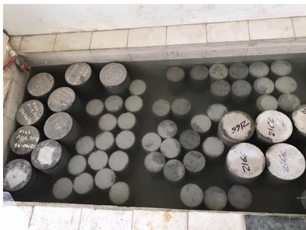
**Figura 37. Tanque de curado**
