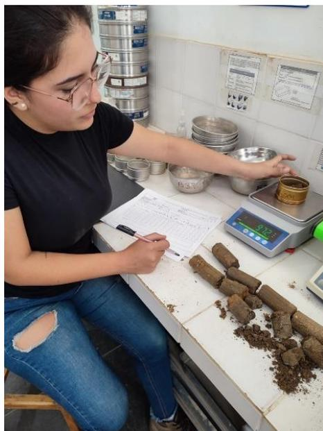
**Figura 28. Se determina la cantidad de muestra requerida para el ensayo**
