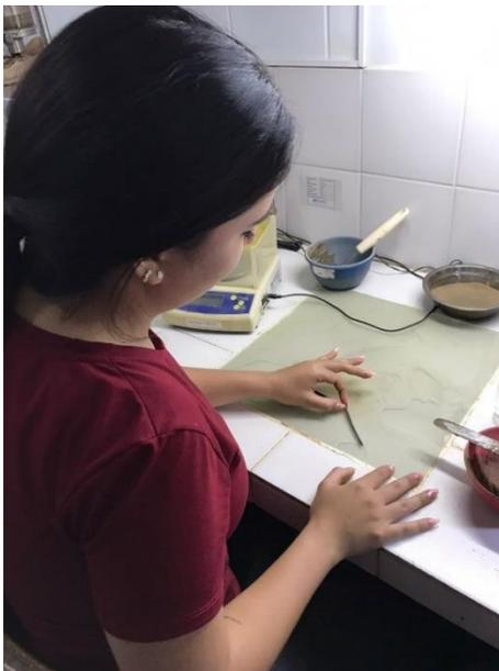
**Figura 14. Procedimiento manual del límite plástico**
