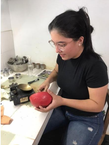
**Figura 7. Se ajusta el contenido de agua poco a poco**
