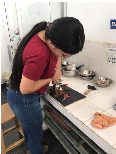
**Figura 32. Introducir la pastilla al aparato de corte**
