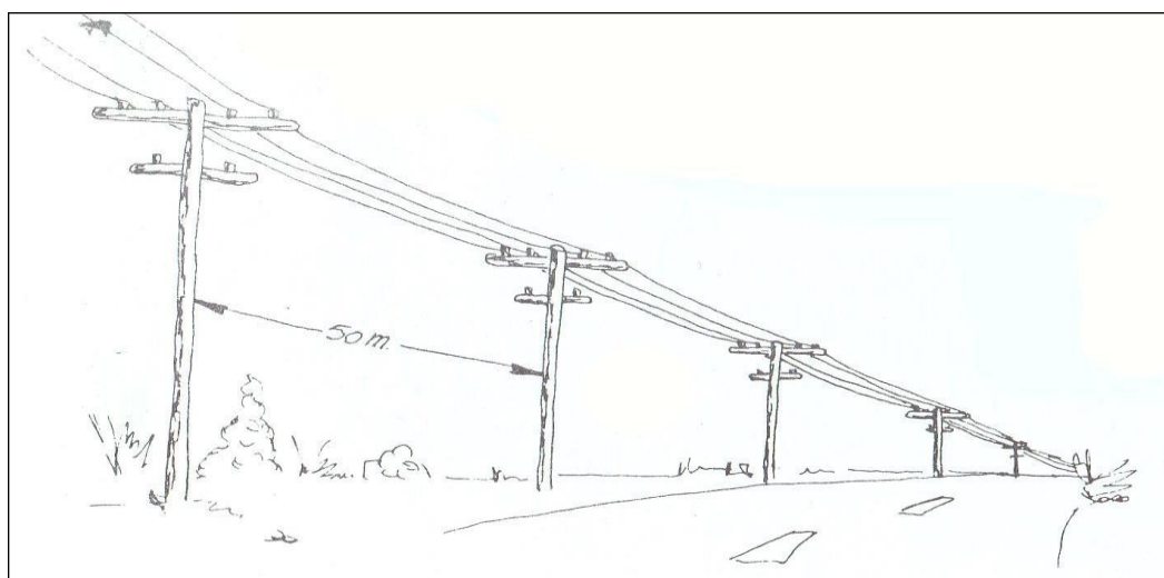
Figura 6. Distancias entre postes de Media Tensión
