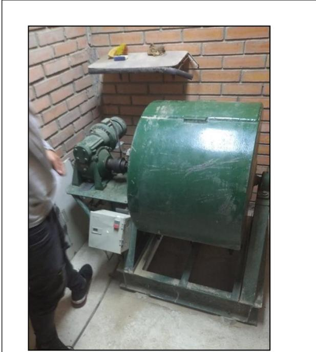
*Fotografía 18. Ensayo de desgaste en la máquina de los ángeles*
