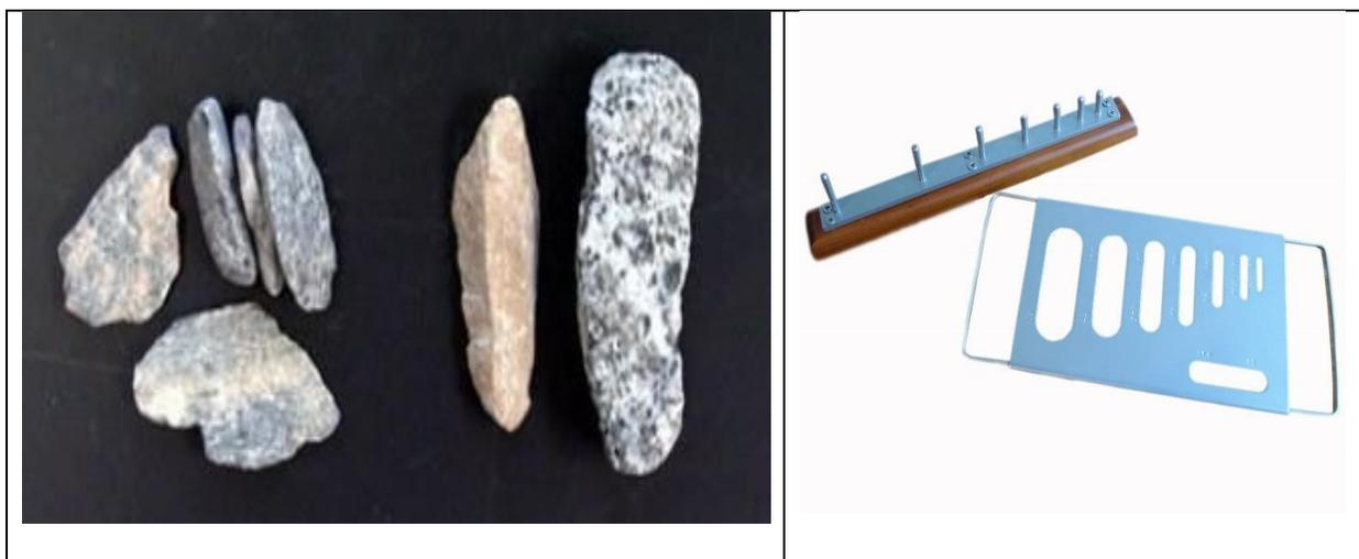
Fotografía 25. Ensayo de Alargamiento y Aplanamiento.
