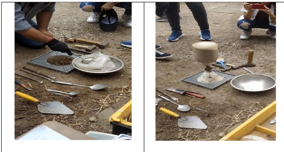
*Fotografía 16. Ensayo Densidad de campo por el método del cono de arena*
