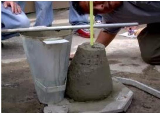
La prueba de asentamiento es realizada con el fin de verificar que el asentamiento con el cual fue diseñada la mezcla se esté cumpliendo, en caso de que este no se cumpla se procede a realizar un ajuste por humedad.
