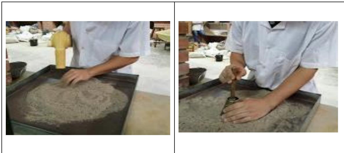
*Fotografía 19. Ensayo absorción del agregado fino.*
