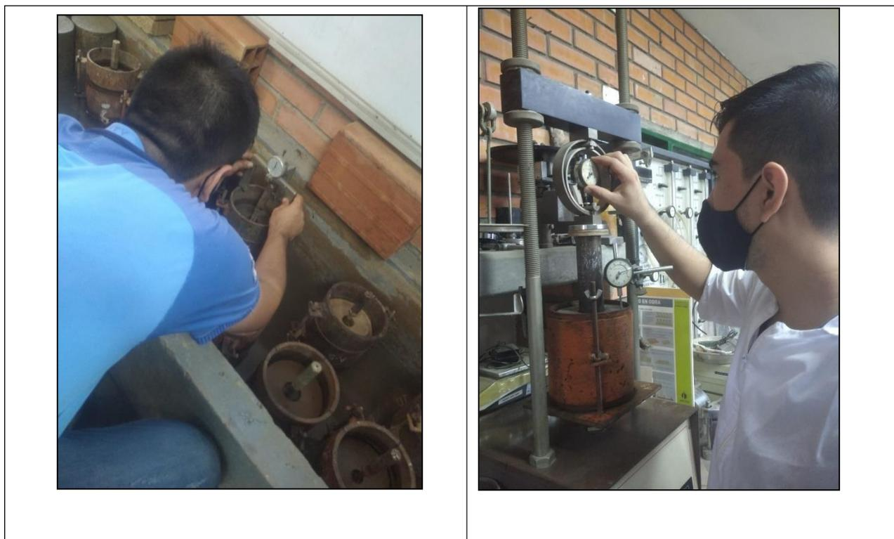
*Fotografía 24. Ensayo de cbr inalterado*
