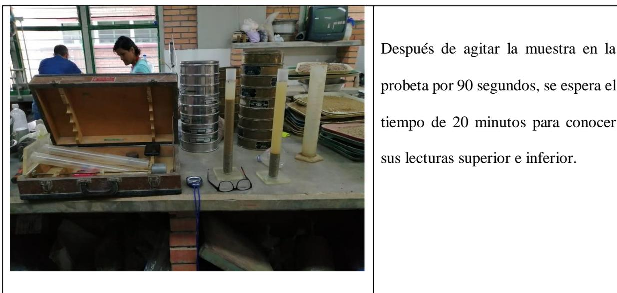
*Fotografía 14. Ensayo Equivalente de Arena*
