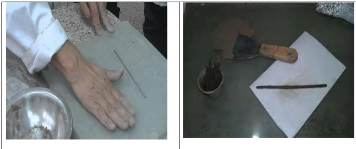
*Fotografía 12. Ensayo de límite Plástico*
