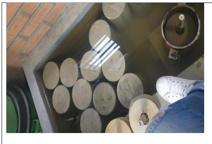
*Fotografía 22. Ensayo de Elaboración y curado de Cilindros de Concreto.*
