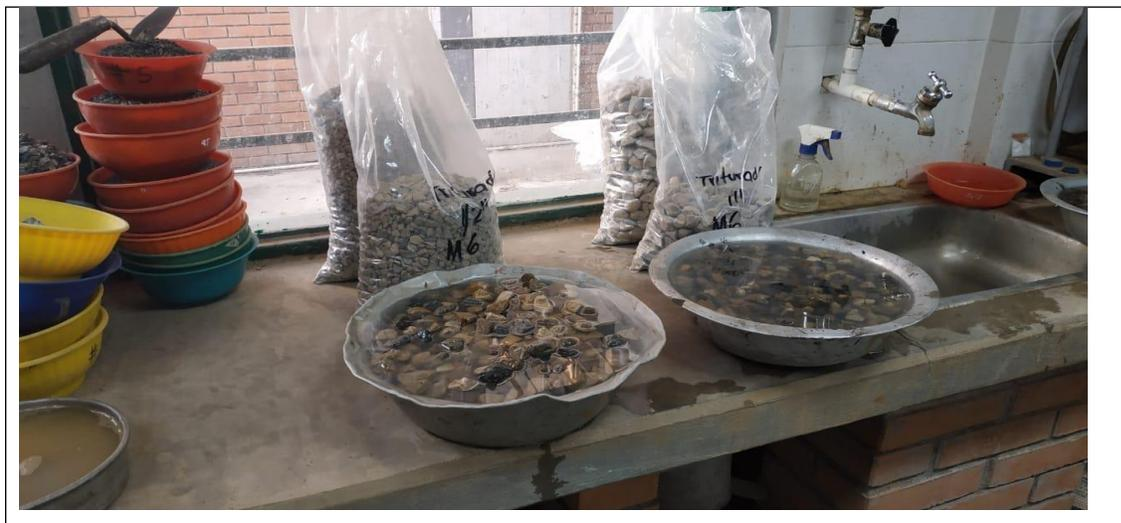
*Fotografía 20. Ensayo absorción del agregado grueso.*
