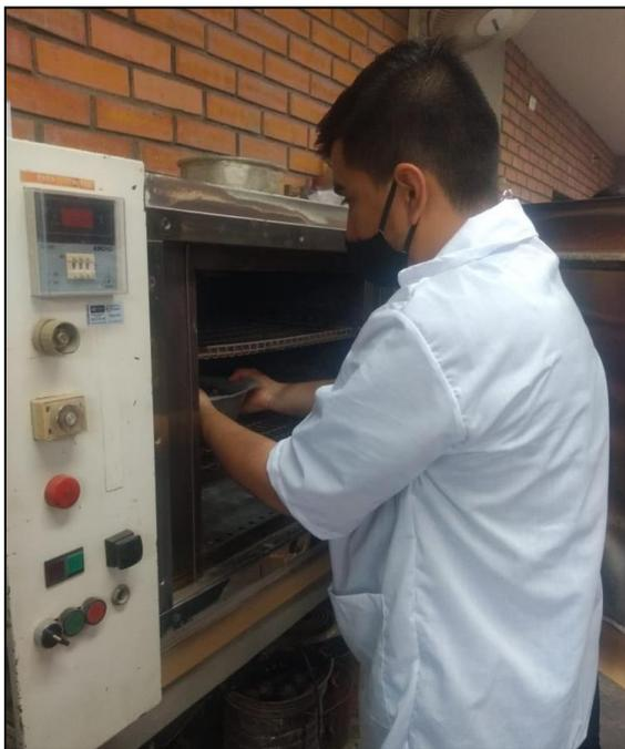
*Fotografía 9. Ensayo de humedad natural.*
