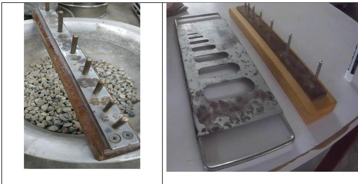
Fotografía 21. Ensayo de caras fracturadas al agregado grueso.
