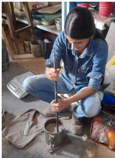
Figura 32. Compactación de la muestra
