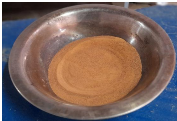
Figura 11. Material pasa tamiz 40 para mezclar
