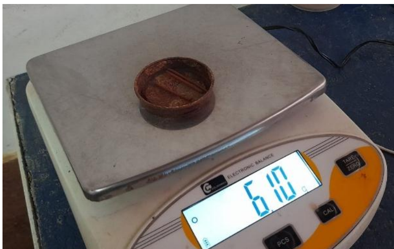
Figura 18. Peso del límite plástico
