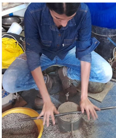
Figura 33. Remoción de excesos de muestra
