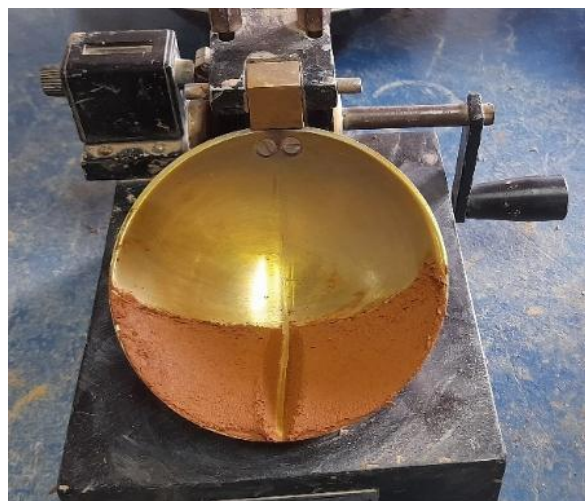
Figura 13. Ranura que divide la capa
