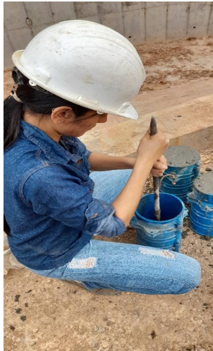
Figura 38. Golpes para eliminar los vacíos
