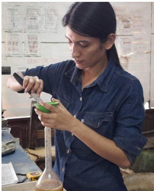
Figura 27. Introducción de la muestra al picnómetro
