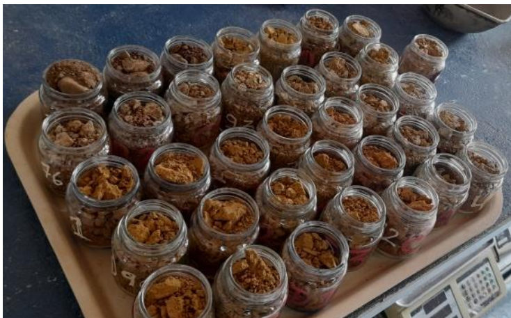
Figura 6. Recipientes sacados del horno
