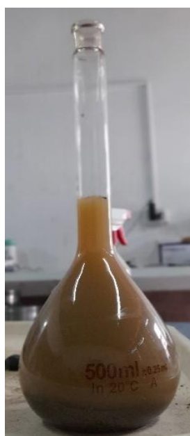
Figura 30. Muestra sin presencia de burbujas, ni vacíos
