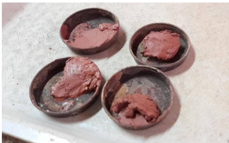
Figura 16. Muestras de cada intervalo de golpes
