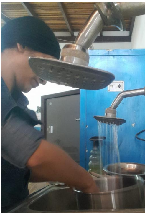
Figura 7. Lavado del material por el tamiz 200
