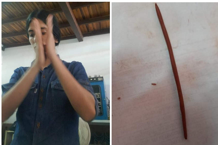
Figura 17. Forma de la muestra para límite plástico
