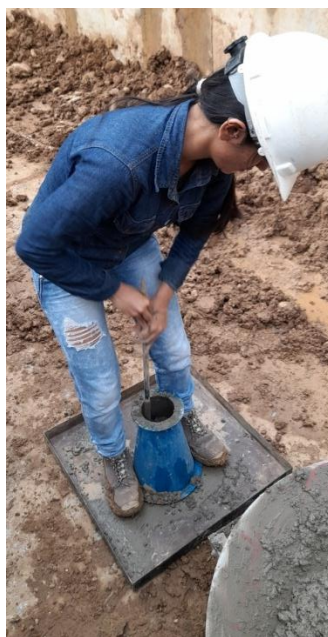
Figura 34. Golpes a la primera capa de mezcla
