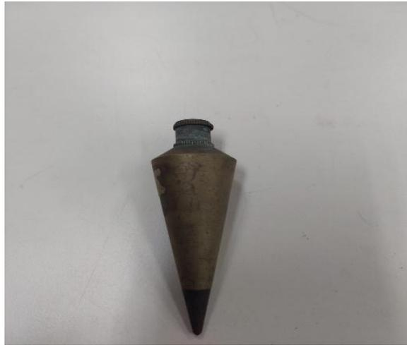
**Figura 7. Plomada metálica**
