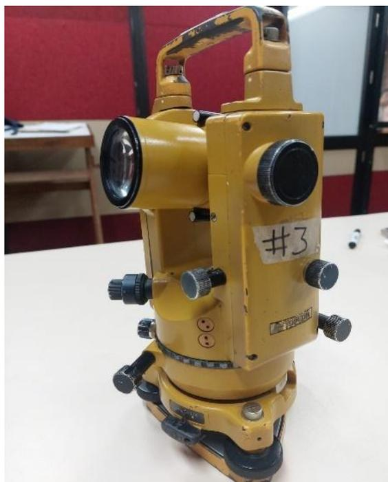
**Figura 9. Teodolito mecánico (Topcon TL- 6)**
