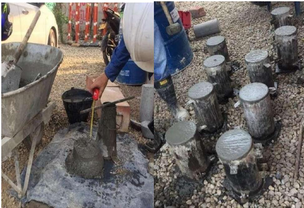
**Figura 54. Ensayos para fundida del estribo**
