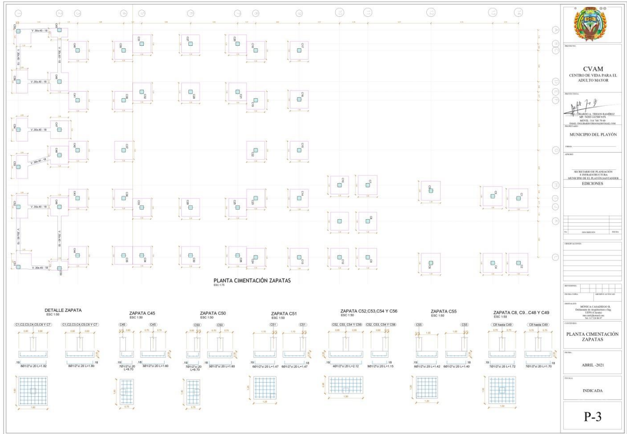
Figura 17. Cimentación para Zapatas.
