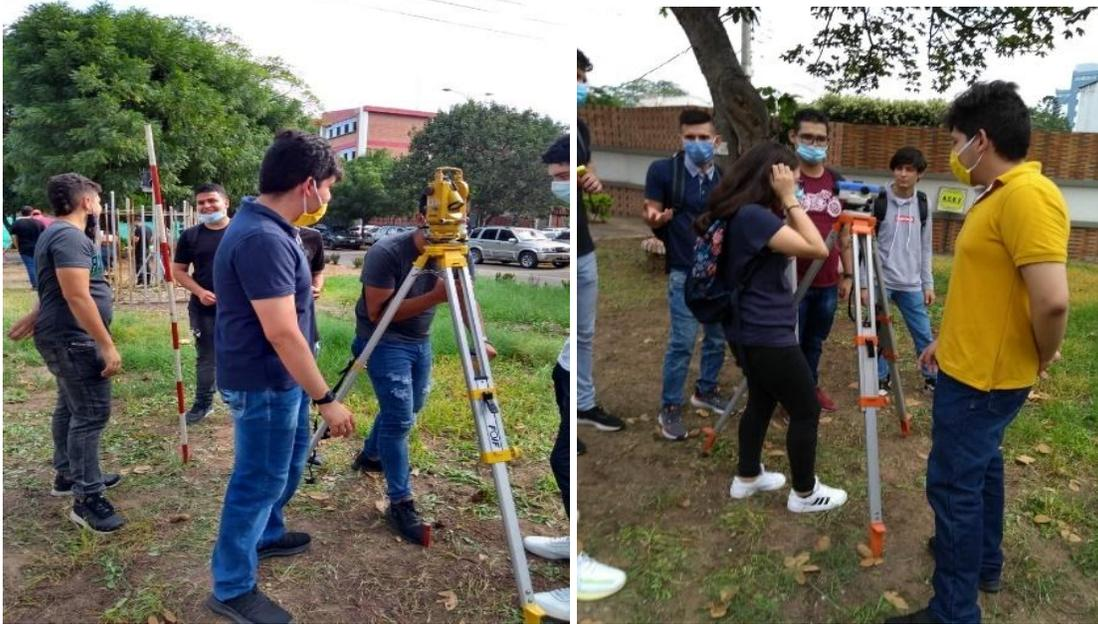
Armado, nivelado, encerado y toma de azimut con teodolito
