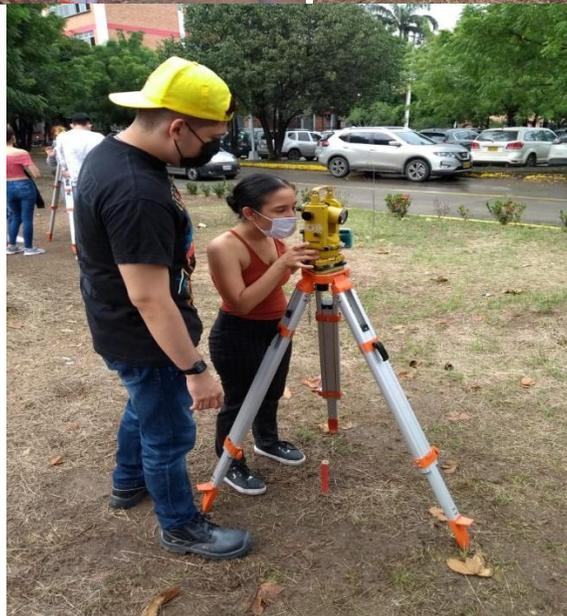
Armado y nivelación de teodolito y nivel
