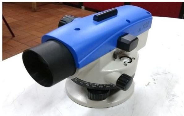
**Figura 6. Nivel de precisión topográfico**
