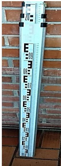
**Figura 8. Mira topográfica**
