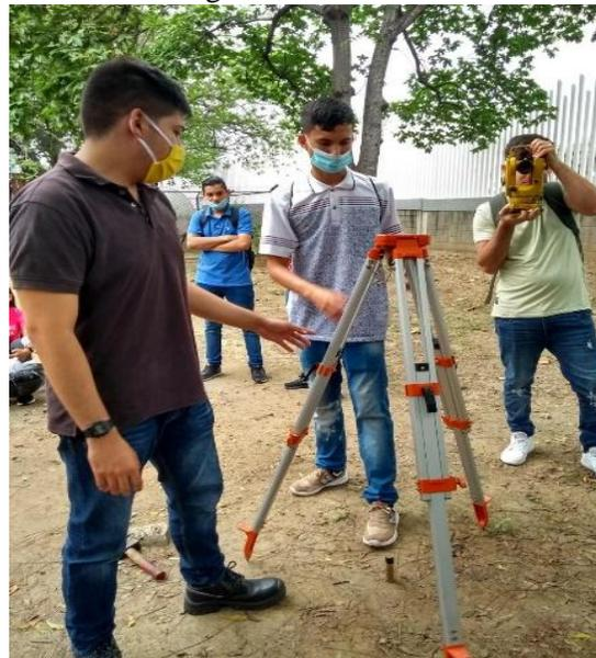
**Anexo 2. Practica. Armado, nivelación, encerado y toma de azimut con teodolito mecánico**
