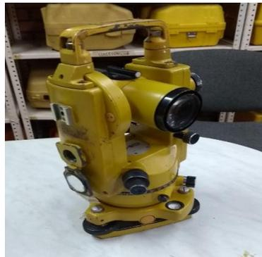
**Figura 4. Teodolito mecánico**
