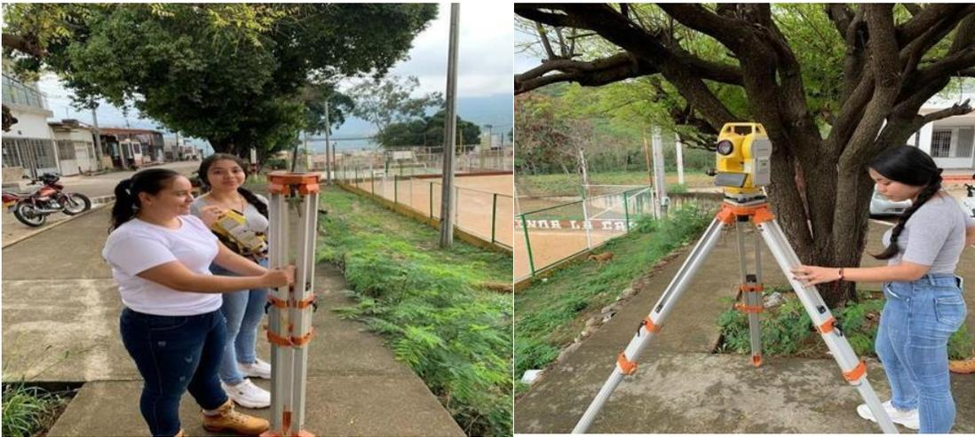
En la figura 2 se evidencian los equipos de trabajo utilizados en este caso para realizar el respectivo levantamiento topográfico de la cancha ubicado en el polideportivo comunal del barrio Tierra Linda en el municipio de Los Patios, Norte de Santander, en el que se hizo uso del teodolito.
