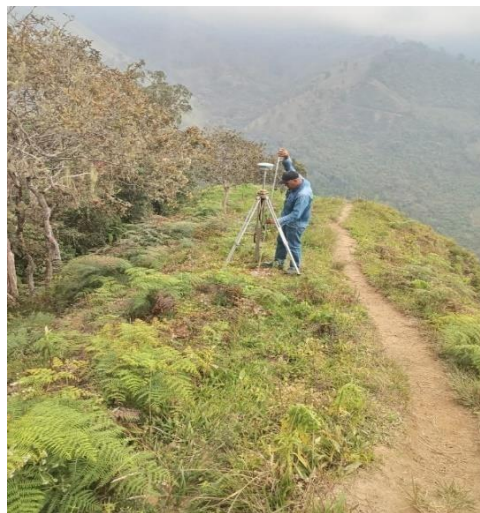
Figura 47. Tomando la altura instrumental del mojón N° 1
