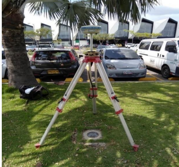
Figura 33. Georreferenciación del Mojón N° 2 del aeropuerto Camilo Daza
