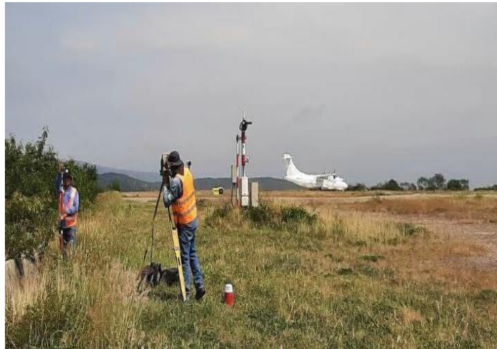
Figura 38. Realizando el proceso de radiación de puntos importantes a plasmar en el plano
