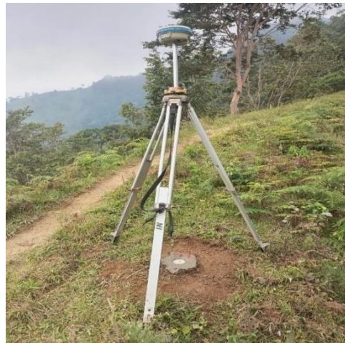
Figura 45. Una vez este armado del equipo GNSS Base para inicio del proceso de georreferenciación, es importante para este proceso encender la base y tomar los datos necesarios
