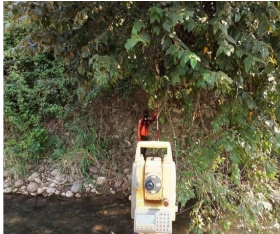
Figura 55. Realizando el proceso de radiación de puntos en el río
