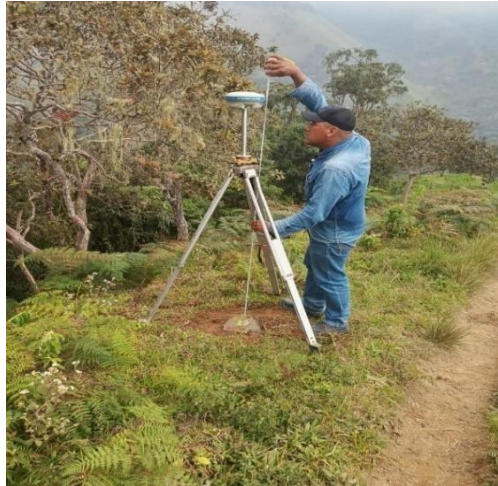
Figura 48. Tomando la altura instrumental del mojón N° 2
