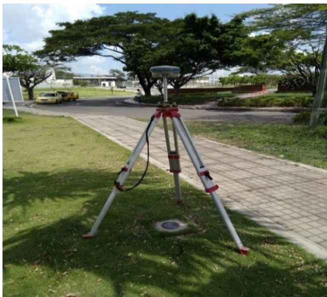
Figura 32. Georreferenciación del Mojón N° 1 del aeropuerto Camilo Daza
