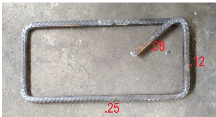
Figura 29. Foto de estribos utilizados para las vigas de placa entre piso
