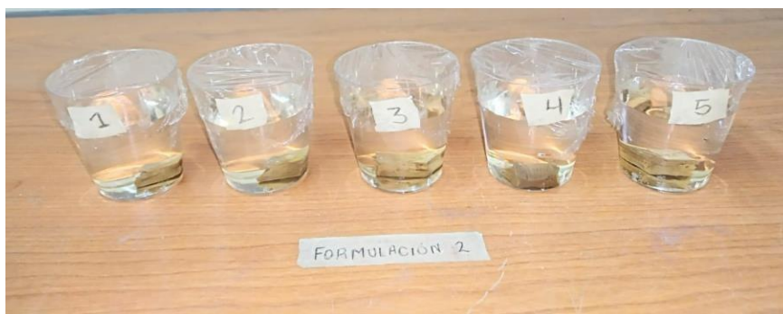
Figura 29. Desarrollo del ensayo solubilidad de la segunda formulación del bioplástico.
