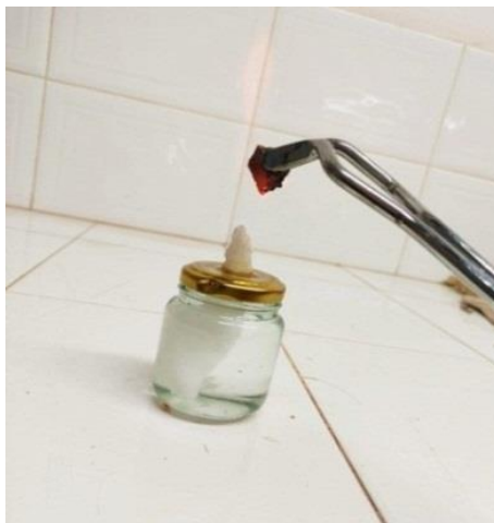
Figura 34. Desarrollo del ensayo inflamabilidad de la primera formulación del bioplástico.
