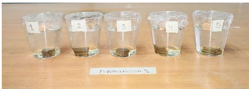
Figura 25. Desarrollo del ensayo solubilidad de la primera formulación del bioplástico.
