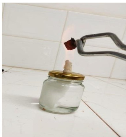
Figura 35. Desarrollo ensayo inflamabilidad de la segunda formulación del bioplástico.
