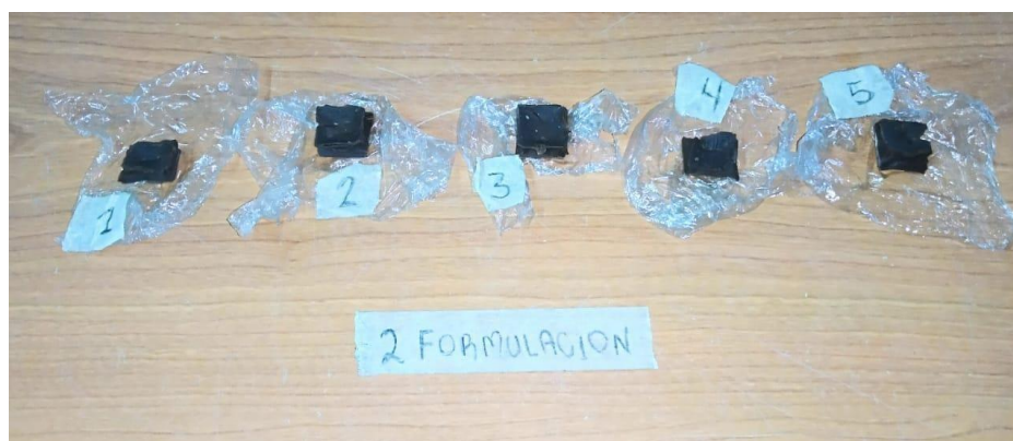
Figura 31. Muestras de la segunda formulación al estar secas - ensayo de solubilidad.
