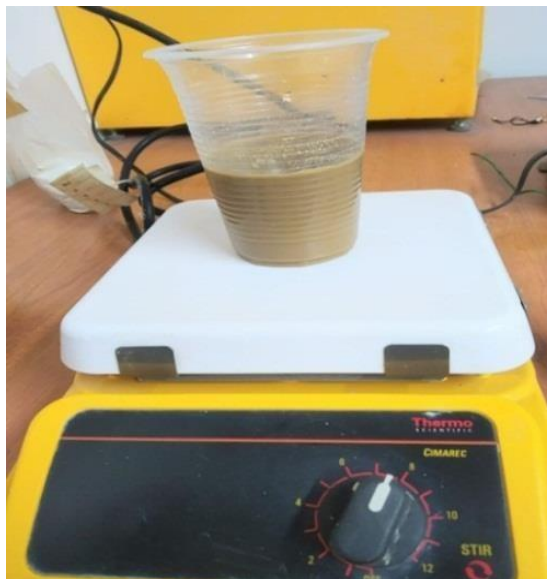
Figura 14. Proceso de agitación y homogenización.
