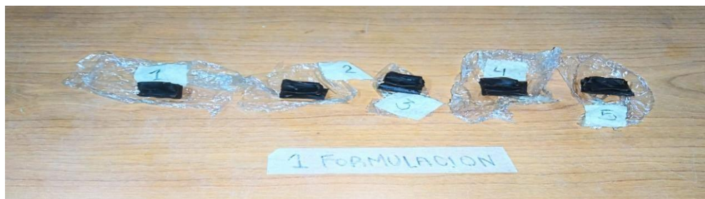
Figura 27. Muestras de la primera formulación al estar secas - ensayo de solubilidad.
