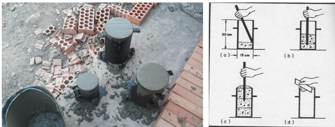
**Figura 21. Prueba control del concreto**
