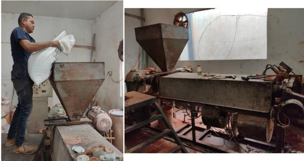
Figura 12. Proceso de peletizado
