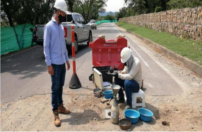
**Figura 13. Ensayo de granulometría**
