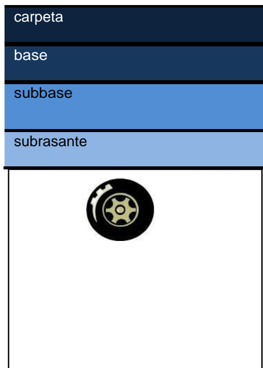
Figura 2. Esquema típico del paquete estructural de un pavimento flexible. Fuente. Tomado de “Cálculo del índice de condición del pavimento flexible en la av. Luis Montero, Distrito Castilla” de Rodríguez, 2009, pág. 3.
