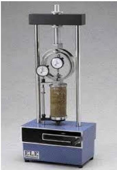
**Figura 4. Maquina ensayo inconfinada**
