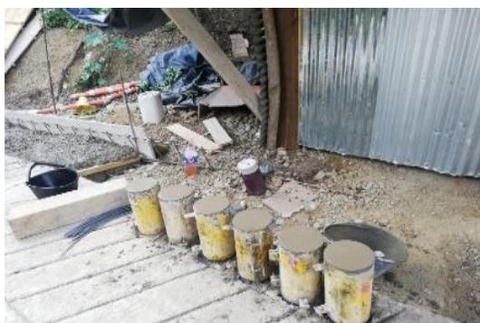
**Figura 21. Muestras y control de concretos**
