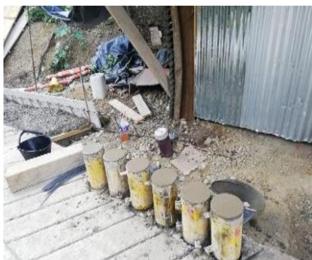
**Figura 16. Muestras y control de concretos**
