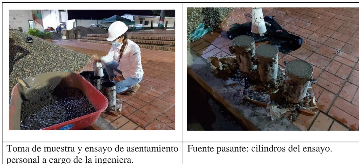
**Figura 43. Toma de muestra y ensayo de asentamiento personal a cargo de la ingeniera.**
