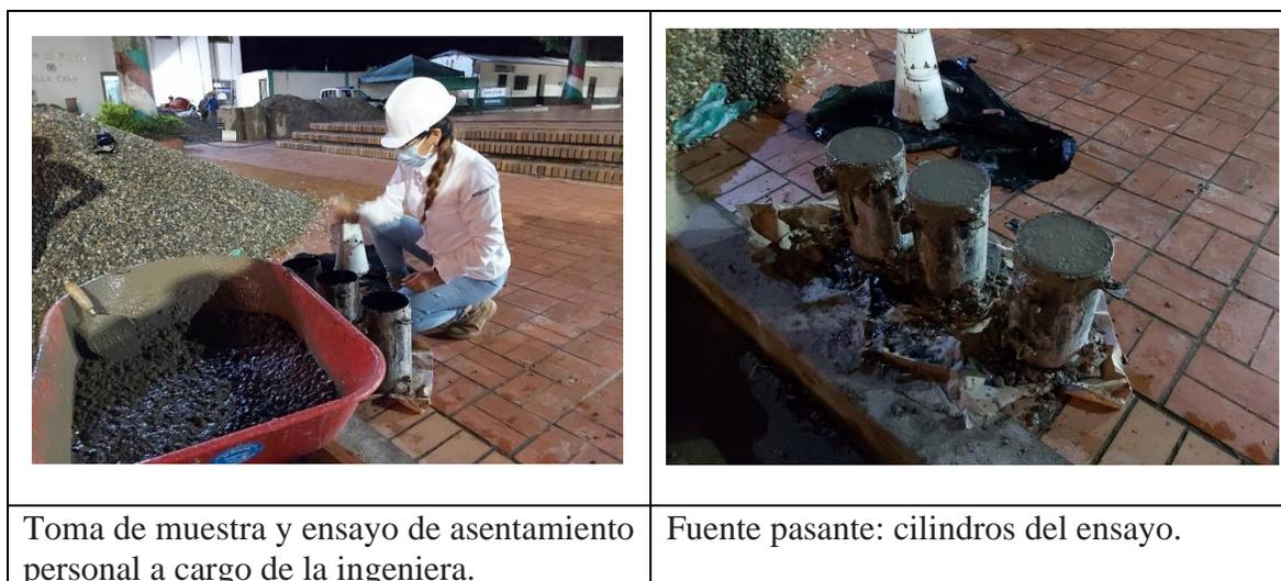
**Figura 64. Toma de muestra y ensayo de asentamiento personal a cargo de la ingeniera**
